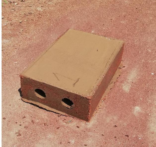
**Foto 9:** Ladrillo artesanal listo para su proceso de secado y luego cocción.
