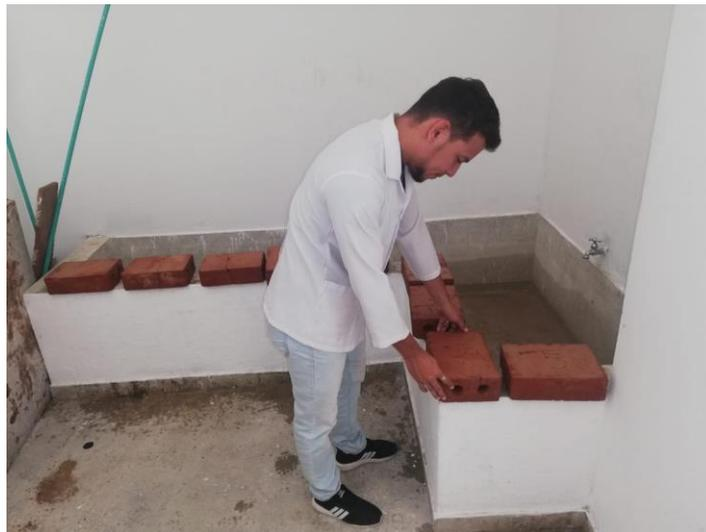
**Foto 24:** Proceso de escurrida del exceso de agua en los ladrillos.
