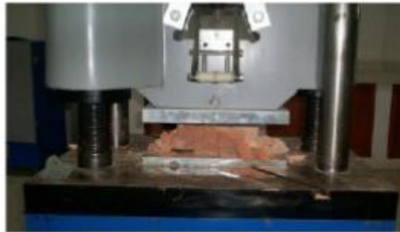
**Ilustración 2.** Ensayo de compresión en ladrillos.
