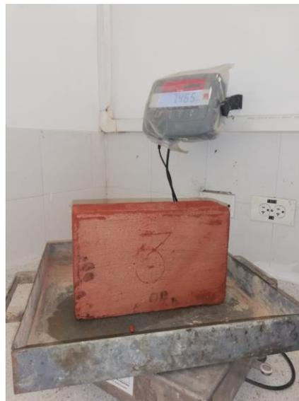
**Foto 26:** Proceso de pesaje de la muestra de 3% de adición de aserrín saturada.
