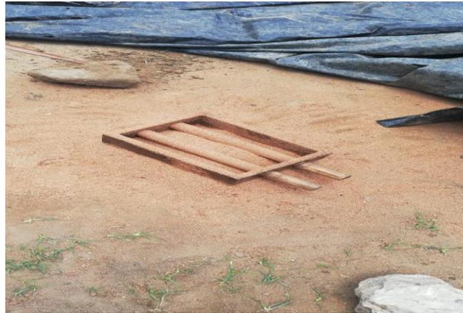
**Foto 11:** Molde en madera para la realización de las muestras.
