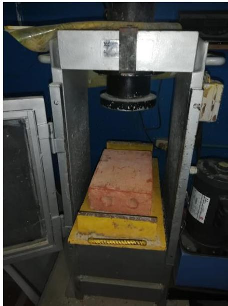
**Foto 16:** Realización de ensayo de compresión a muestras de ladrillos con adición de 3% aserrín.
