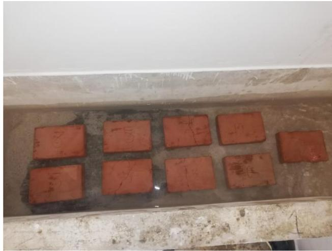
**Foto 23:** Proceso de saturación de ladrillos en una alberca, durante 24h.
