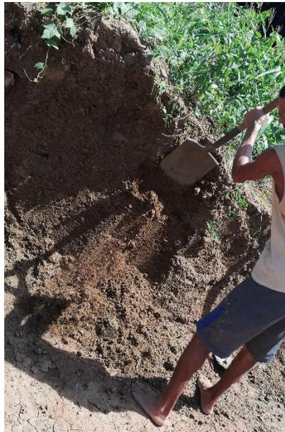
**Foto 2:** Proceso de extracción del material para la elaboración del ladrillo.
