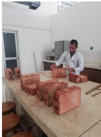
**Foto 22:** Preparación para pesaje de los ladrillos secos.
