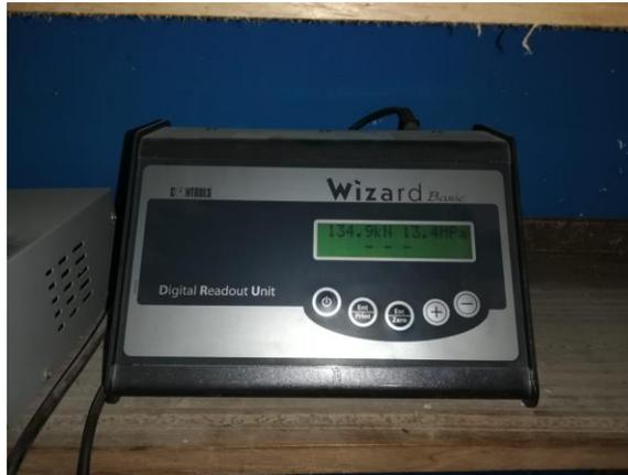
**Foto 17:** Datos obtenidos en máquina de ensayos de compresión a muestras de ladrillos con adición de 3% aserrín.
