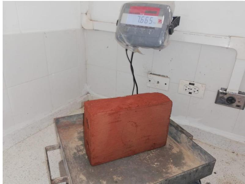
**Foto 25:** Proceso de pesaje de la muestra patrón saturada.
