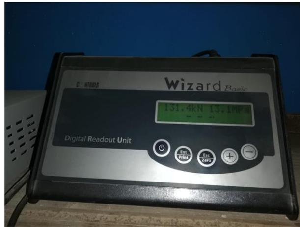
**Foto 19:** Datos obtenidos en máquina de ensayos de compresión a muestras de ladrillos con adición de 5% aserrín.
