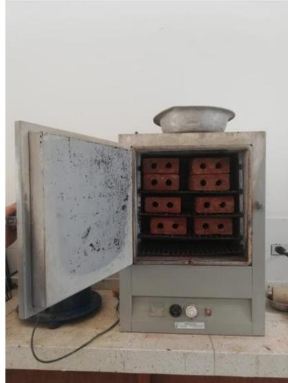
**Foto 21:** Proceso de secado a través de una estufa a 110°C durante 24horas.
