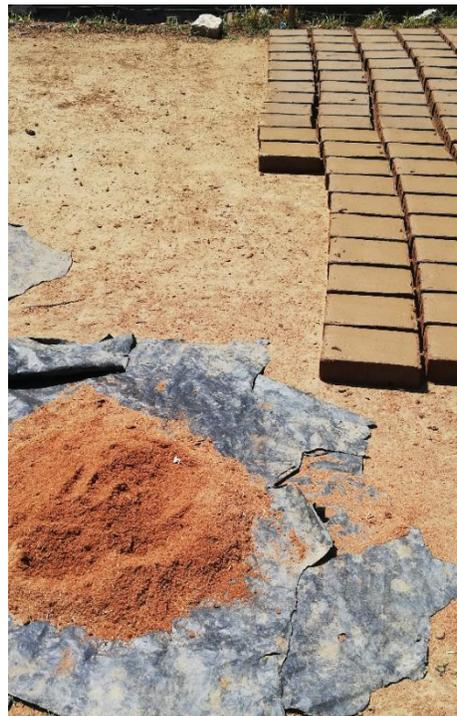
**Foto 12:** Aserrín; ladrillos en proceso de secado al sol.
