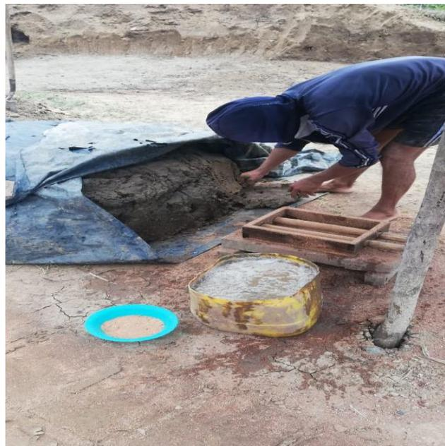
**Foto 6:** Adición de aserrín a la masa según su dosificación correspondiente.
