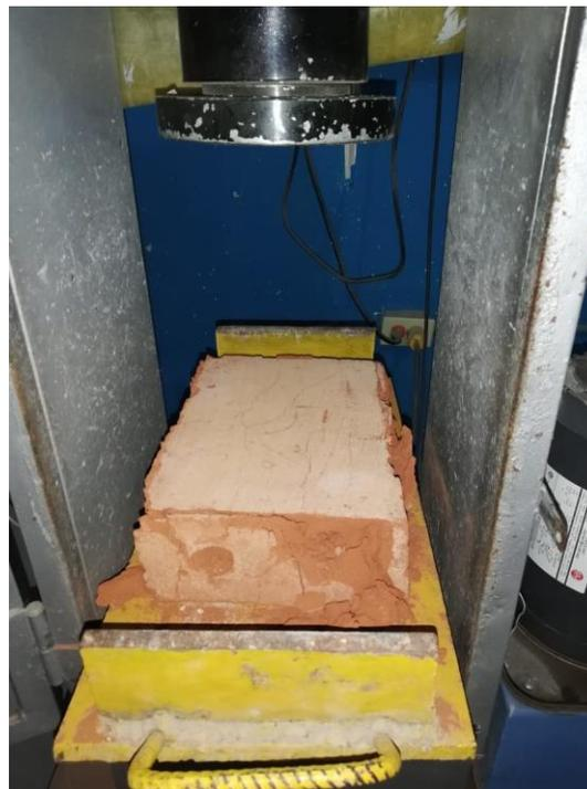
**Foto 18:** Realización de ensayo de compresión a muestras de ladrillos con adición de 5% aserrín.
