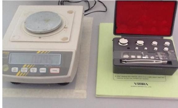
Figura 2. Balanza Analítica PCB - KERN & SOHN gmbh 350-3.
