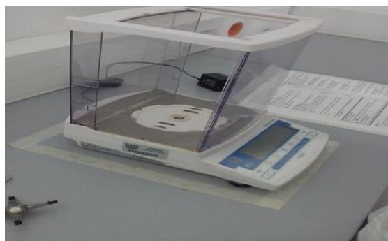
Figura 11 Balanza Analítica Vibra Modelo HT 224 Verificación antes de Calibrar.
