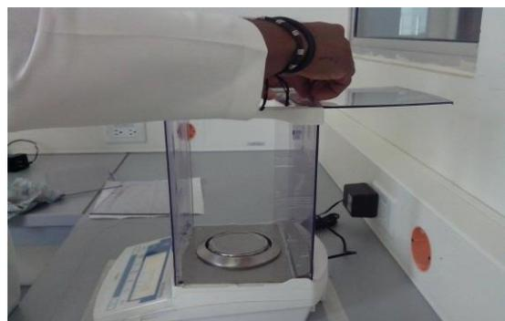
Figura 11 Balanza Analítica Vibra Modelo HT 224 realizando Pruebas de Calibración.
