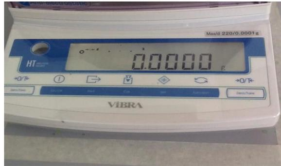
Figura 6. Balanza Analítica Vibra Modelo HT 224.
