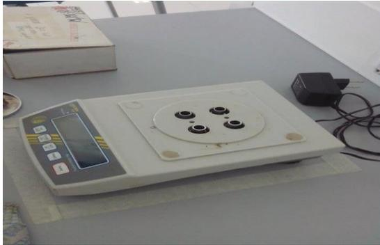
Figura 10 Balanza Analítica 10 PCB - KERN & SOHN gmbh 350-3 limpieza.
