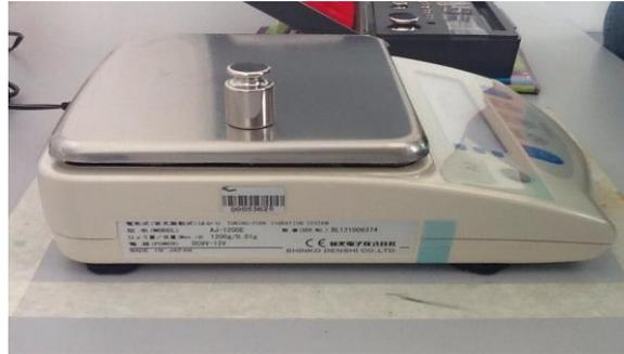
Figura 4. Balanza Analítica Vibra Japón Modelo AJ-1200E.
