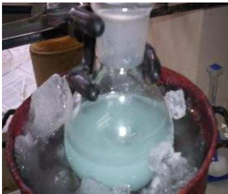
Figura 7. Proceso de recolección del heteropolimolibdato de cobre
