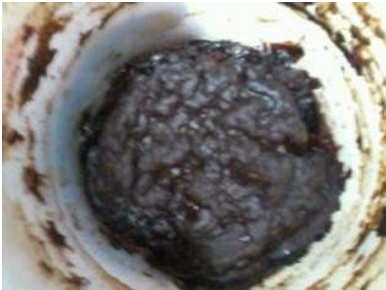
Figura 10. Aspecto del gel RF (Secado, ni calcinar)
