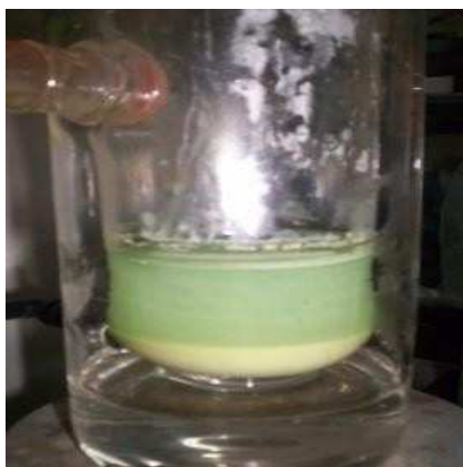
Figura 6. Desprendimiento lateral y vidrio poroso del reactor de borosilicato
