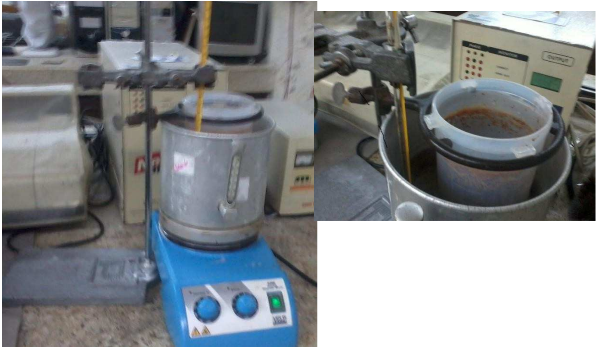
Figura 9. Montaje para la síntesis de carbón nanoporoso (gel RF)
