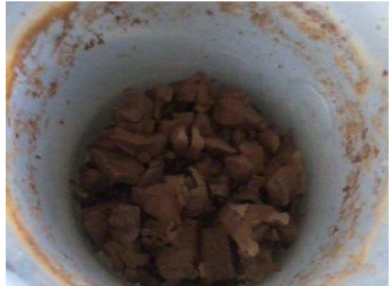
Figura 11. Aspecto del gel RF (Sin (Secado, sin pulverizar, sin calcinar)
