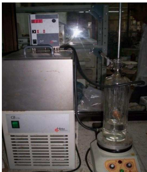
Figura 5. Reactor de borosilicato con mangueras para conectar al baño termostatado.
