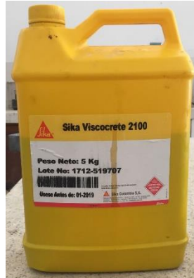
Ilustración 6. Aditivo supe plastificante utilizado en las muestras adicionadas con fibras.
