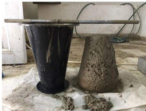
Ilustración 14. Ensayo de Slump realizado a la muestra patrón.
