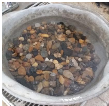
Ilustración 12. Agregado pétreo sumergido en agua destilada con el fin de desprender las partículas deleznable.
