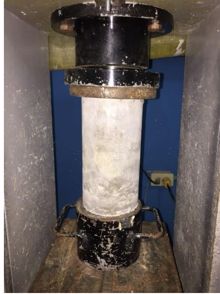
Ilustración 16. Medición de la resistencia a compresión del cilindro de concreto en la prensa hidráulica.
