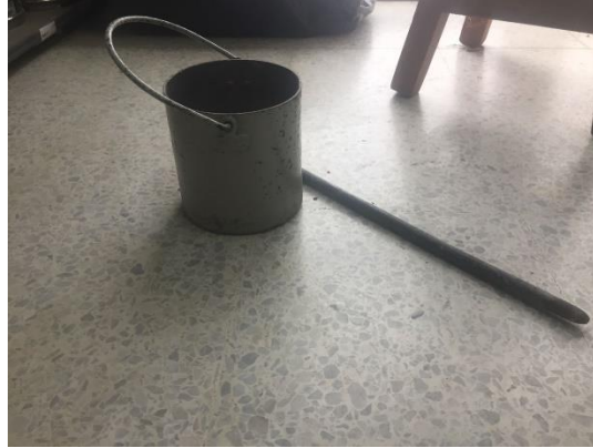
Ilustración 8. Recipiente de volumen conocido y varilla compactadora que permite hallar densidad bulk.
