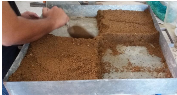
Ilustración 7. Reducción de las muestras del agregado pétreo empleado el método de cuarteo.
