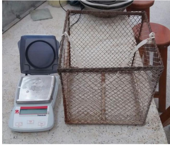
Ilustración 11. Balanza y canasta metálica utilizada en la realización del ensayo.
