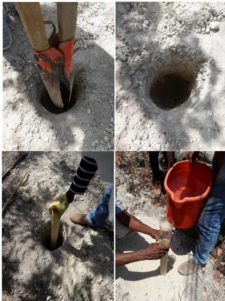
**Figura 12.** Ensayo de permeabilidad in situ en la zona de recarga potencial.
