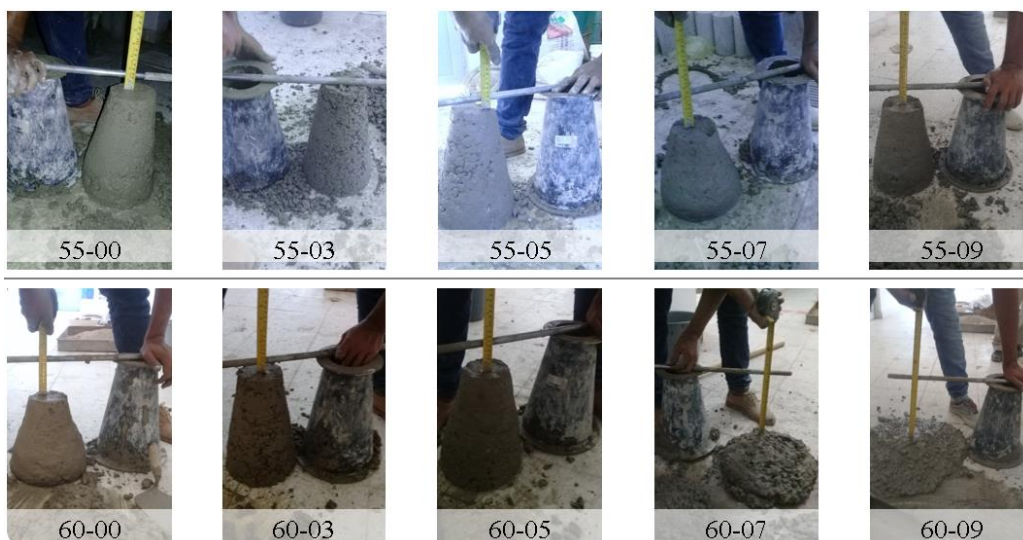
Figura 22 Ensayo de asentamiento de las distintas mezclas de concreto
