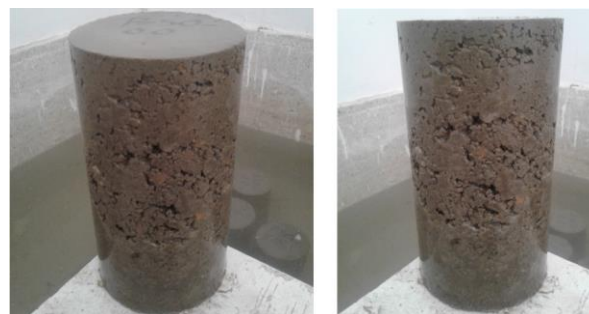
Figura 12 Muestras huecas superficialmente de relación a/c 0.50
