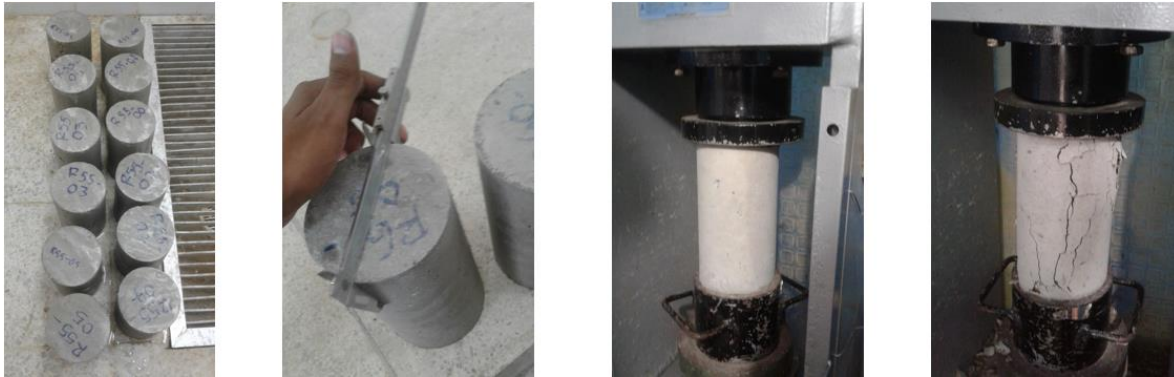
Figura 23 Procedimientos del ensayo de resistencia a la compresión de las probetas de concreto
