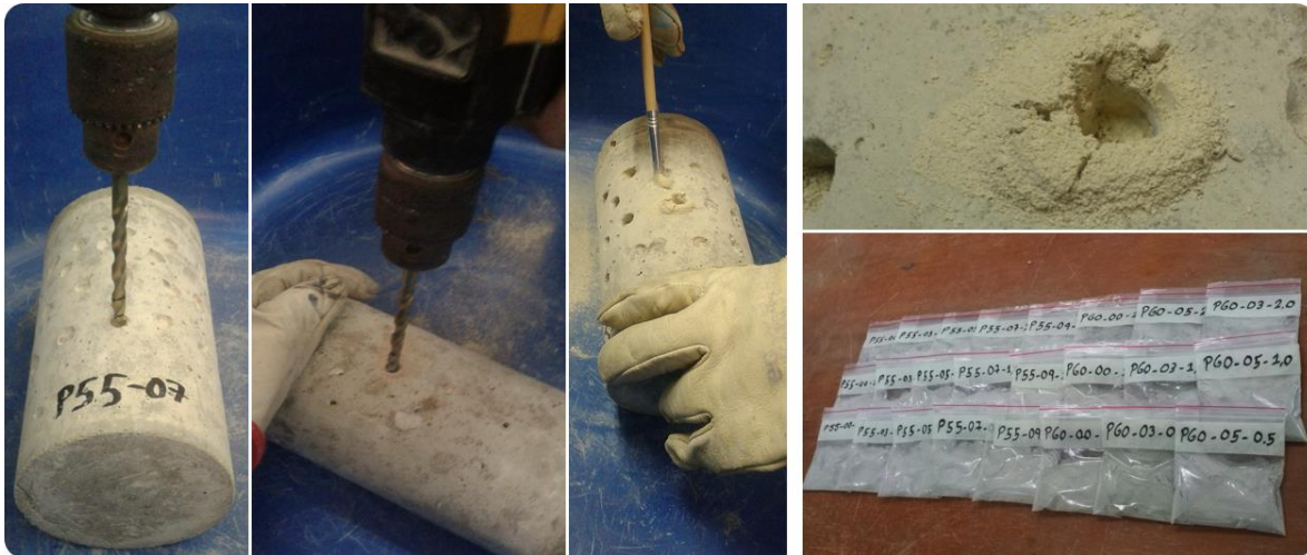
Figura 20 Obtención de las muestras pulverizadas de hormigón en las diferentes profundidades
