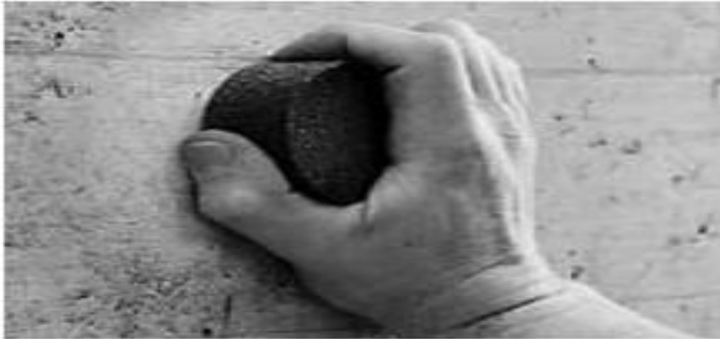
Figura 3. Preparación de la superficie de ensayo.
