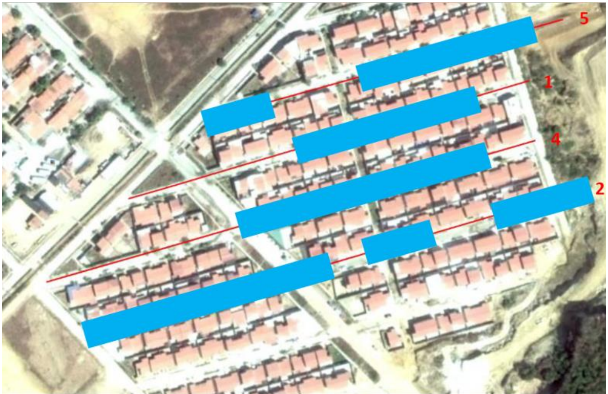
Figura 53. “Zonas con presencia de saturación a lo largo de las líneas analizadas con respecto a resistividades bajas hasta los 6m de profundidad”
