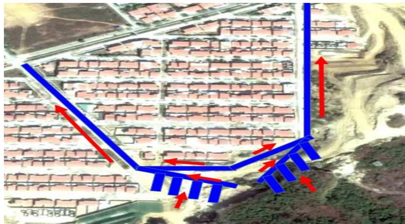
Figura 59. “Direccionamiento del flujo con canales colectores espina de pescado”
