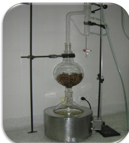
Imagen 1: Sistema de arrastre con vapor
