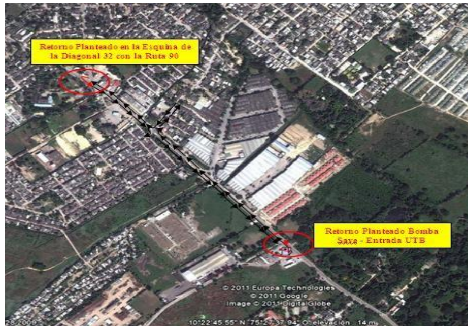
Figura 7. Retornos diseñados como solución para la intersección San José de Los Campanos.
