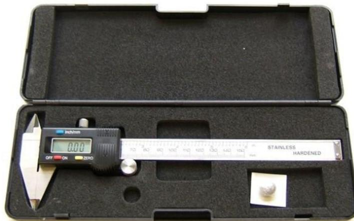
Imagen 3. Calibrador digital
