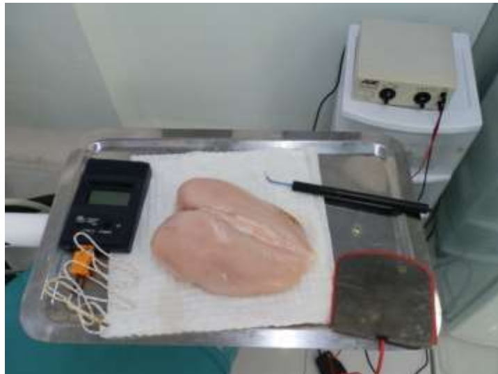
Figura 1: instrumental. Termómetro digital industrial Lutrón® TM902, pechuga de pollo simulando tejidos blandos, electro bisturí Bonart® con electrodo T4.
