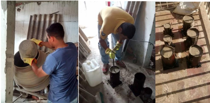
Figura 11. Elaboración y curado de los cilindros.
