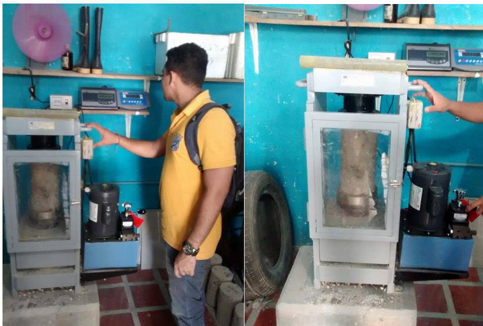
Figura 12. Ensayo de compresión a los cilindros.
