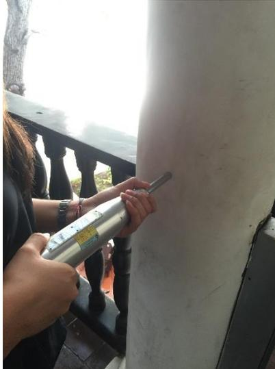
Imagen. 9. Registro fotográfico del ensayo de esclerómetro en las pilastras del pasillo central.
