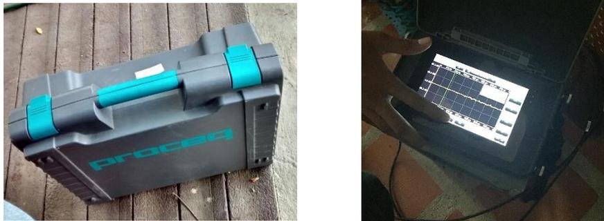
Imagen 4. Izquierda: equipo de ultrasonido; derecha: determinación de la velocidad de onda en la muestra ensayada.
