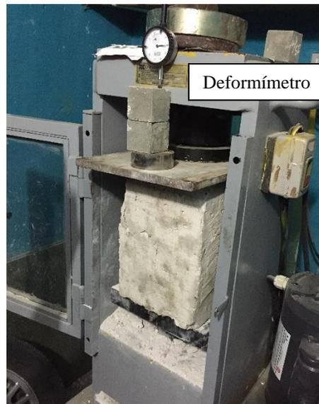
Imagen 5. Ensayo de compresión axial en la maquina universal para la muestra 1.
