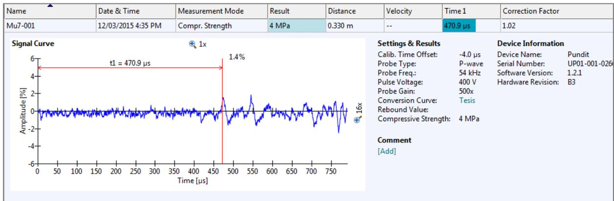
Fig. 19. Resultados del proceso de calibración para las muestras ensayadas.
