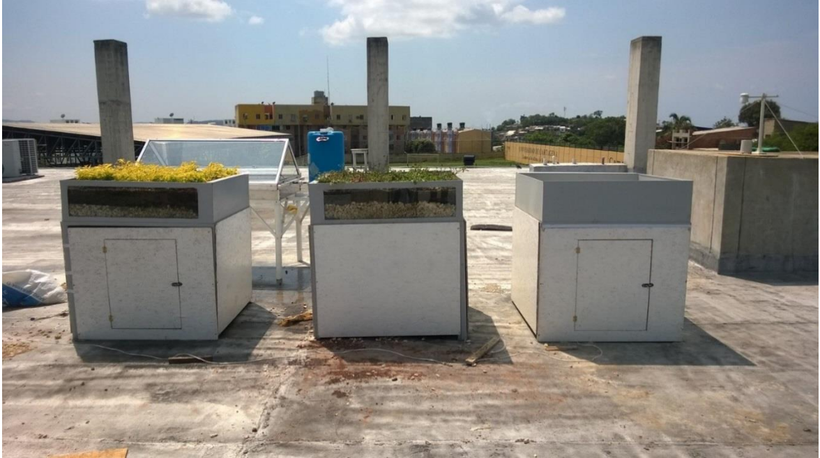
Figura 13. Vista frontal de los modelos de los modelos de techo a escala piloto. De izquierda a derecha: Techo Verde compuesto de Duranta, Techo Verde compuesto de Verdolaga y Cubierta de Concreto Convencional.
