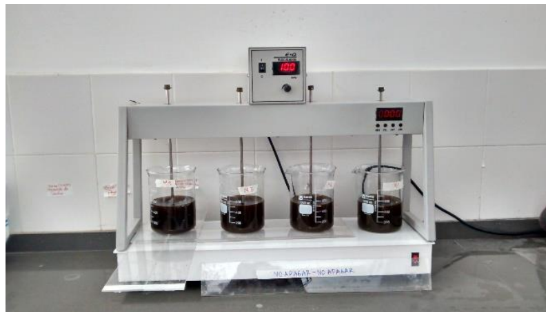
Ilustración 4. Reactores en ensayo de isotermas.
