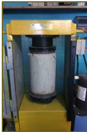
Ilustración 6. Compresión a los 28 días – máquina de compresión. Fuente: Autores
