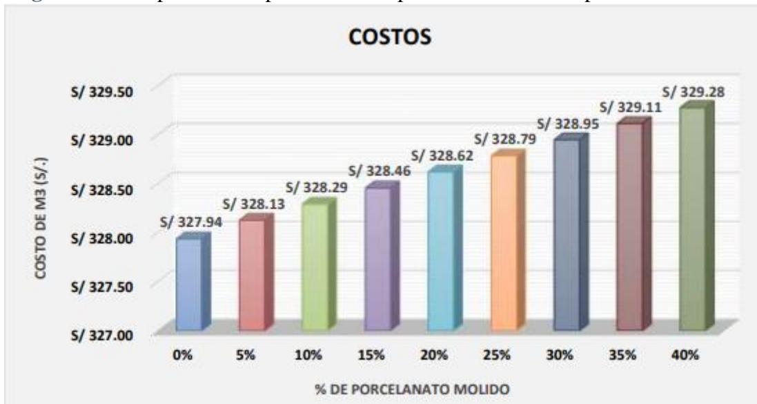
Figura 17. Comparación de precios con respecto a la adición de porcelanato molido
