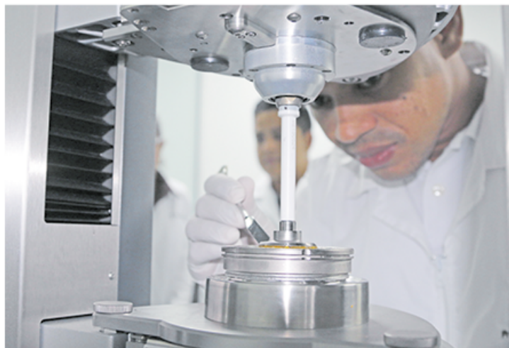
■ El reómetro de esfuerzo controlado es un equipo capaz de desarrollar el análisis bromatológico y las características de cualquier tipo de alimento.
