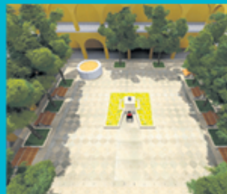
La adaptación del patio central de la Merced incluye un pilar para fijar el busto, iluminación, vegetación, cambio de piso y adaptación de drenajes.
