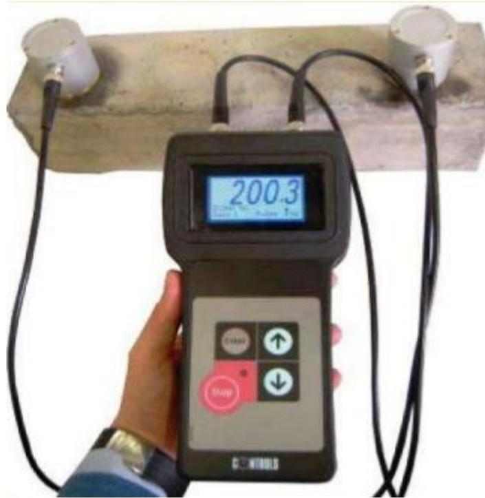
*Ilustración 8 Aplicación del ensayo UPV*
