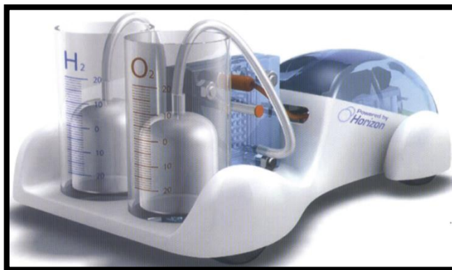
Figura 4. Tanques de almacenamiento exterior e interior del Hydrocar
