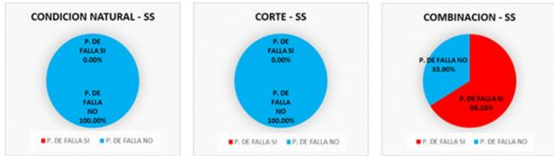
Figura 37. Esquema de resultados de probabilidades de falla más significativas del perfil 5 del sector de San Francisco, en condición sin sismo. Fuente: Autores.
