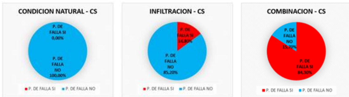
Figura 85. Esquema de resultados de probabilidades de falla más significativas del perfil 2 del sector de Manzanares, en condición con sismo. Fuente: Autores.
