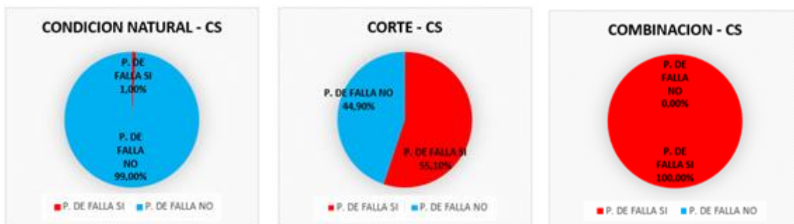
Figura 93. Esquema de resultados de probabilidades de falla más significativas del perfil 6 del sector de Manzanares, en condición con sismo. Fuente: Autores.
