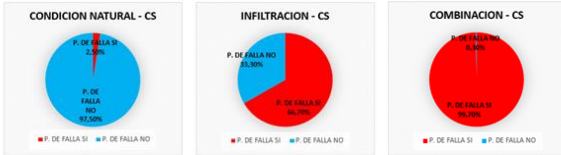
Figura 100. Esquema de resultados de probabilidades de falla más significativas del perfil 4 del sector de Nueva Granada, en condición con sismo. Fuente: Autores.
