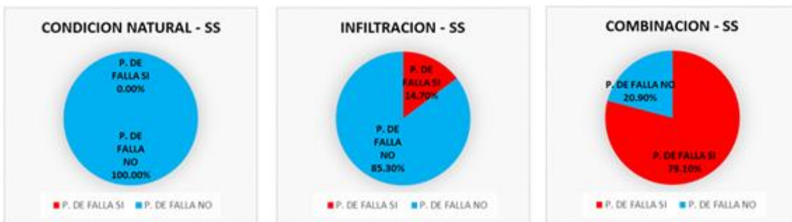
Figura 67. Esquema de resultados de probabilidades de falla más significativas del perfil 4 del sector de Nueva Granada, en condición sin sismo. Fuente: Autores.
