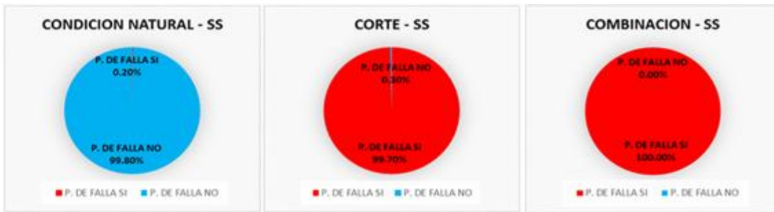
Figura 42. Esquema de resultados de probabilidades de falla más significativas del perfil 1 del sector de Manzanares, en condición sin sismo. Fuente: Autores.
