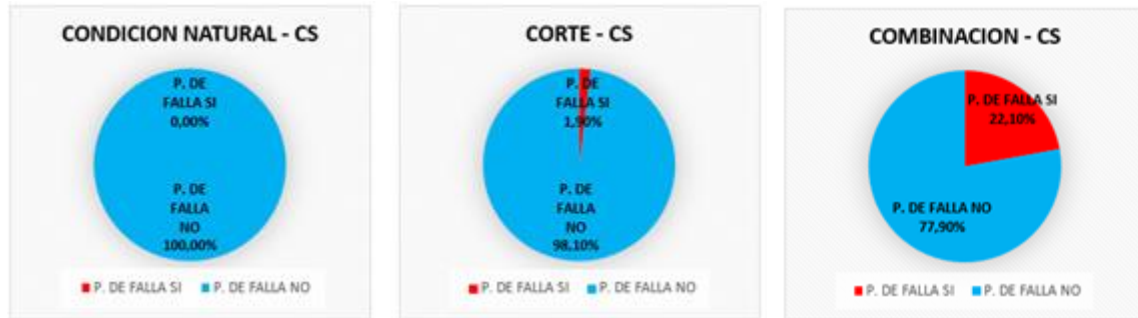
Figura 104. Esquema de resultados de probabilidades de falla más significativas del perfil 6 del sector de Nueva Granada, en condición con sismo. Fuente: Autores.
