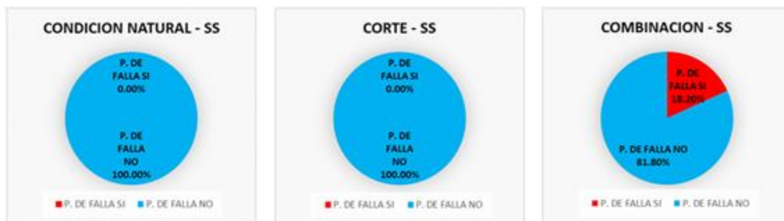
Figura 64. Esquema de resultados de probabilidades de falla más significativas del perfil 3 del sector de Nueva Granada, en condición sin sismo. Fuente: Autores.
