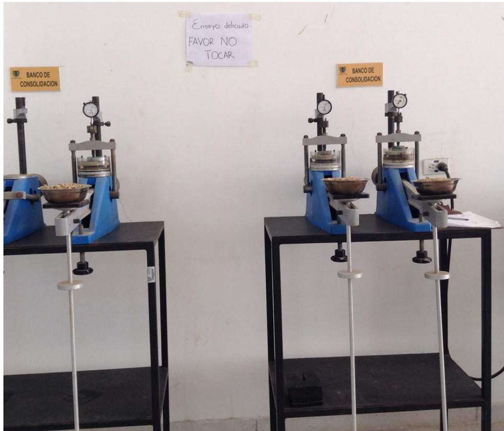
Figura 10. Banco de Consolidación de los laboratorios de Geotecnia y Materiales de la Universidad de Cartagena. En la imagen se ensayan con 16 kg muestras contaminadas con 3%, 5% y 10% de izquierda a derecha.
