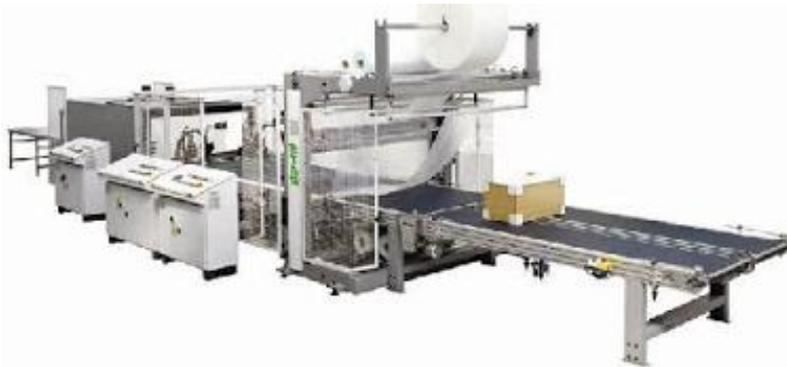
Máquinas automáticas para el embalaje con película de polietileno termo retráctil.
