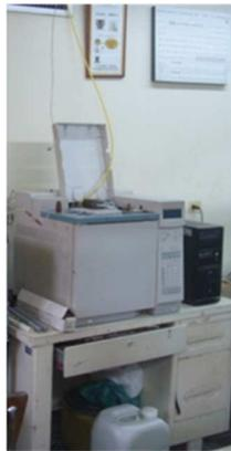
**Figura 27 Cromatografo de gases utilizado para las mediciones de actividad catalítica en la combustión completa de metano**
