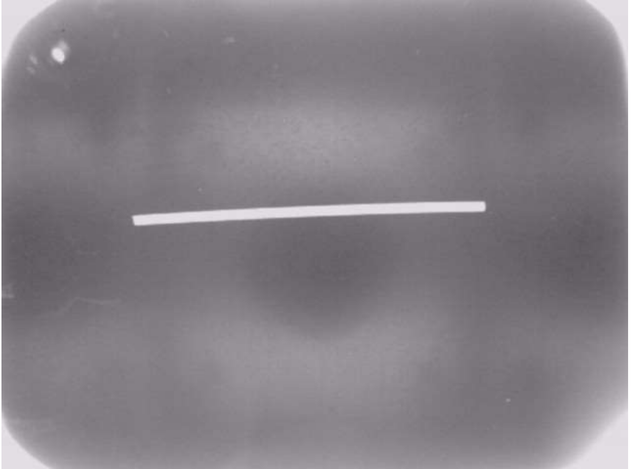
figura 1. Se observa imagen radiográfica del patrón de medida.
