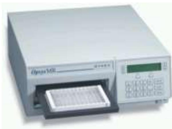
Fig. 3 a) placas de 96 pozos, b) lector de pozo
