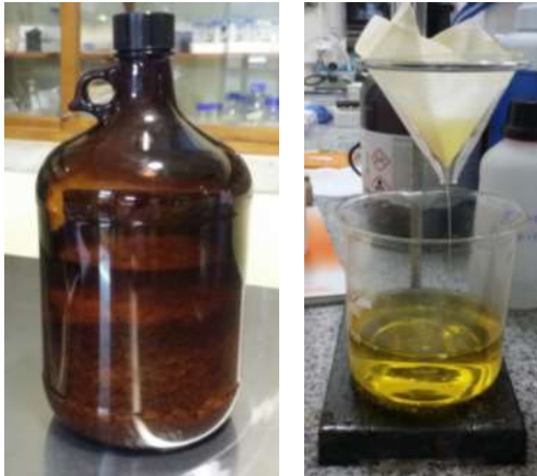
Figura 9. Proceso de Maceración en frío de las semillas de M. americana en Etanol y Proceso de filtración.
