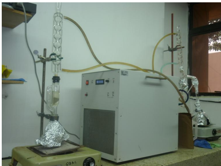
Figura 7. Extracción Soxhlet de suelo – montaje en laboratorio
