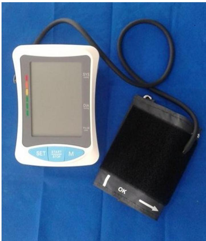
**FIGURA 1.** Tensiómetro digital marca SEJOY BP 1319
