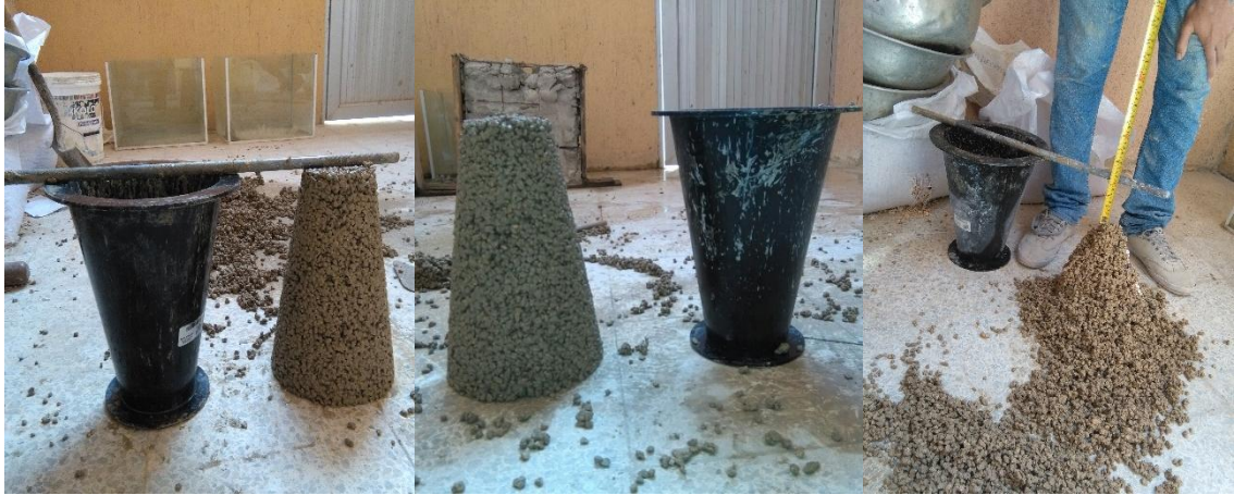
Anexo 7. Pruebas de asentamiento para TC7, TC8 y TC9 (de izquierda a derecha)
