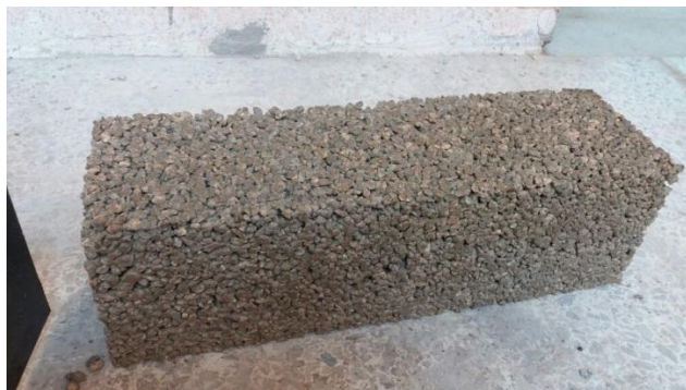
Figura 19. Especímenes prismáticos usados para determinar la resistencia a la flexión
