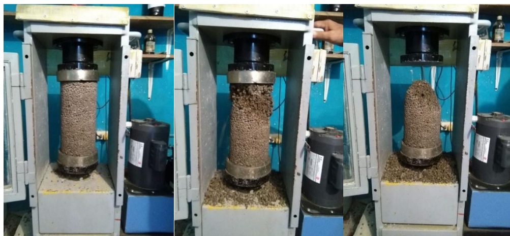
Figura 18. Espécimen antes de ser ensayado (izquierda), durante el ensayo (centro) y después de ser ensayado (derecha)
