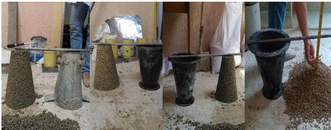
Anexo 5. Pruebas de asentamiento para CR8, TC1, TC2 y TC3 (de izquierda a derecha)
