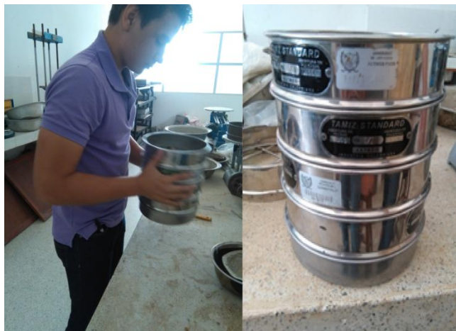
Figura 14. Serie de tamices a la cual es pasada la muestra.
