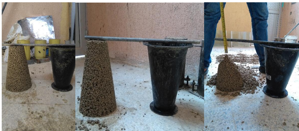
Anexo 6. Pruebas de asentamiento para TC4, TC5 y TC6 (de izquierda a derecha)
