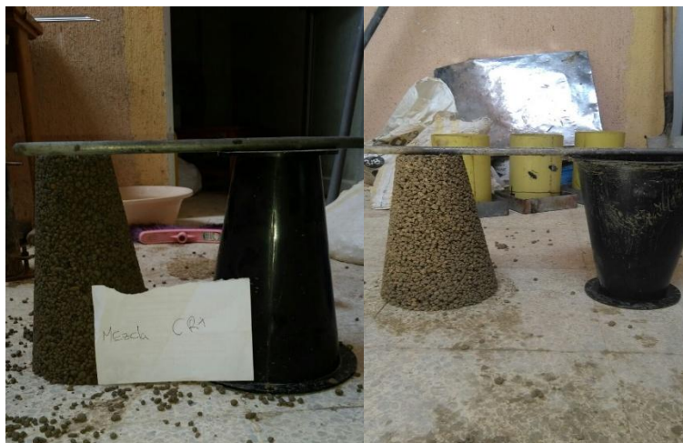
Figura 16. Ensayo de asentamiento para las mezclas CR1 (izquierda) y TC2 (derecha)
