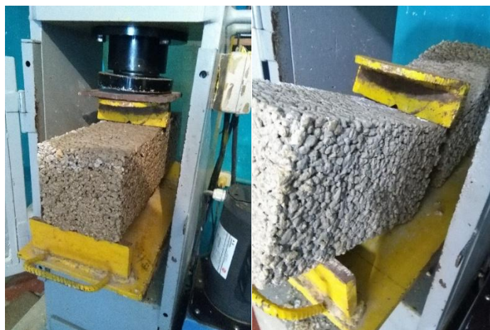
Figura 20. Vigueta ante de ser ensayada (izquierda) y después de ser ensayada (derecha)
