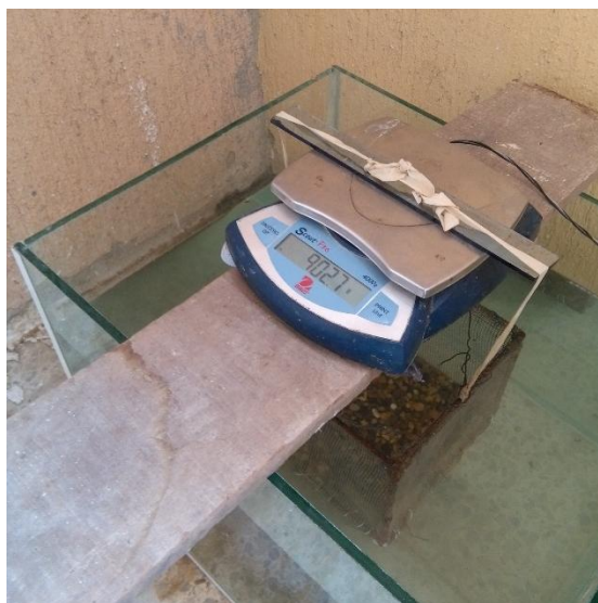
Figura 13. Montaje para determinar el peso sumergido en el ensayo de gravedad específica
