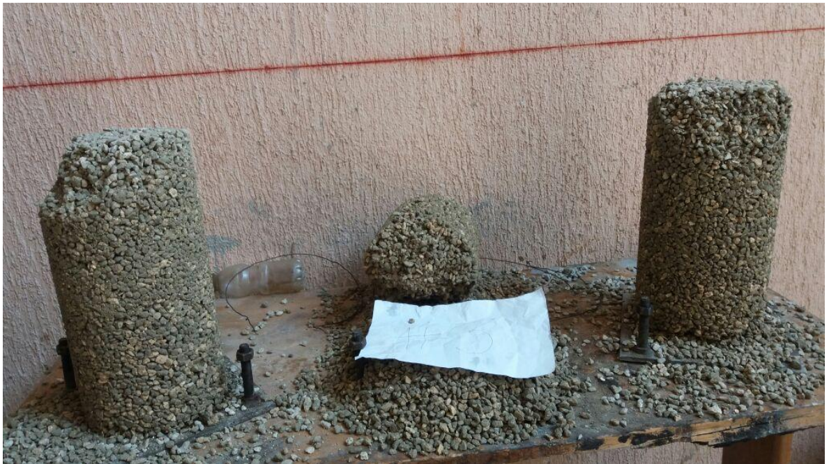
Anexo 8. Cilindros de la mezcla TC3 desmoronados
