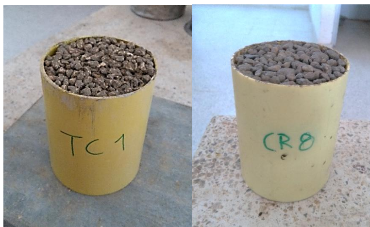
Figura 22. Muestras usadas durante el ensayo de permeabilidad
