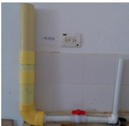
Figura 21. Permeámetro de carga variable usado durante la investigación
