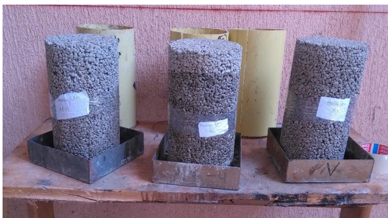
Figura 17. Especímenes cilíndricos usados para determinar la resistencia a la compresión
