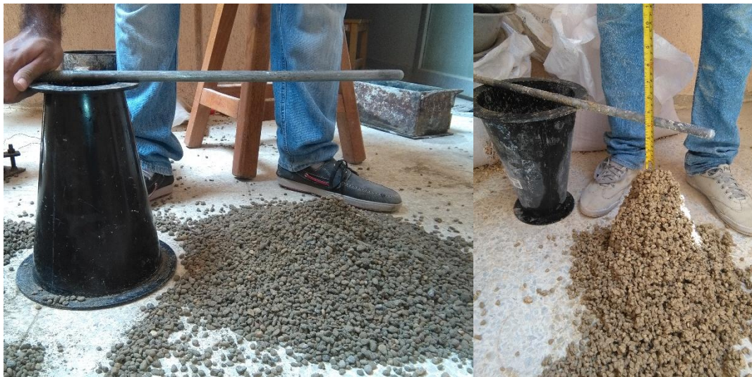
Figura 25. Asentamiento de mezclas con poca agua
