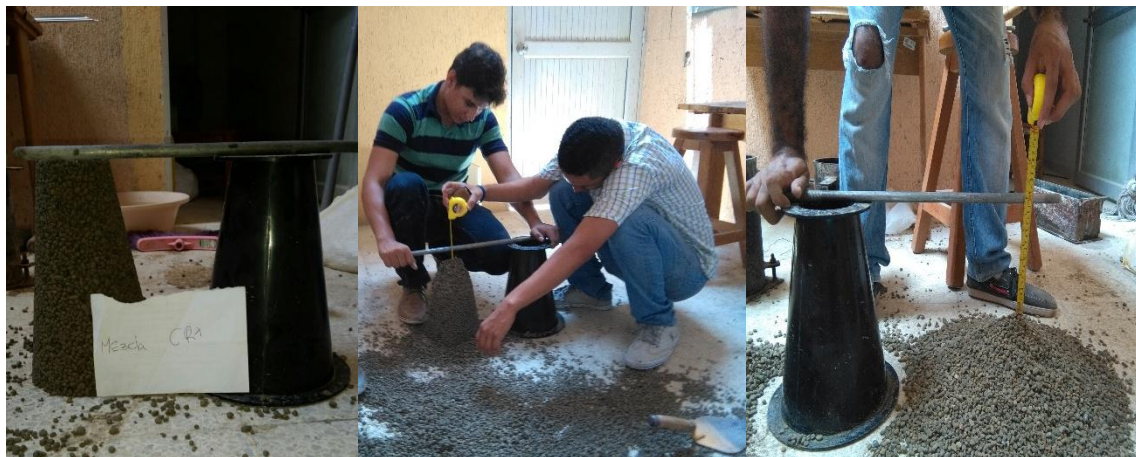
Anexo 3. Pruebas de asentamiento para CR1, CR2 y CR3 (de izquierda a derecha)
