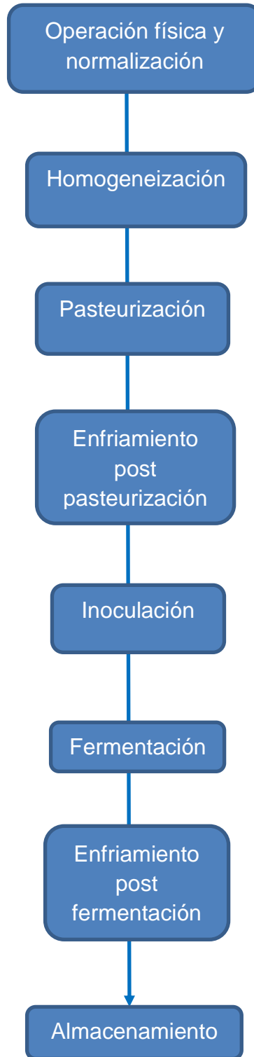
Figura 2. Diagrama De Bloque De La Elaboración De Una Bebida Tipo Yogurt A Base De Lactosuero
