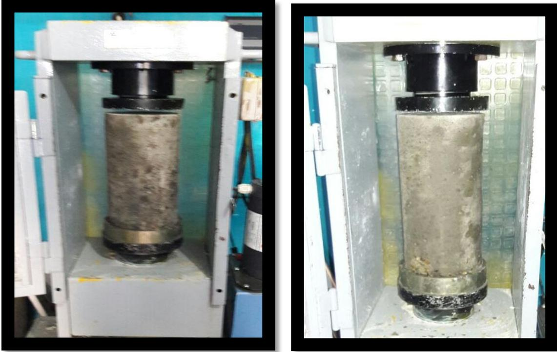
*Figura 20 : Probetas de concreto en la maquina universal de ensayos a la compresi3n*
