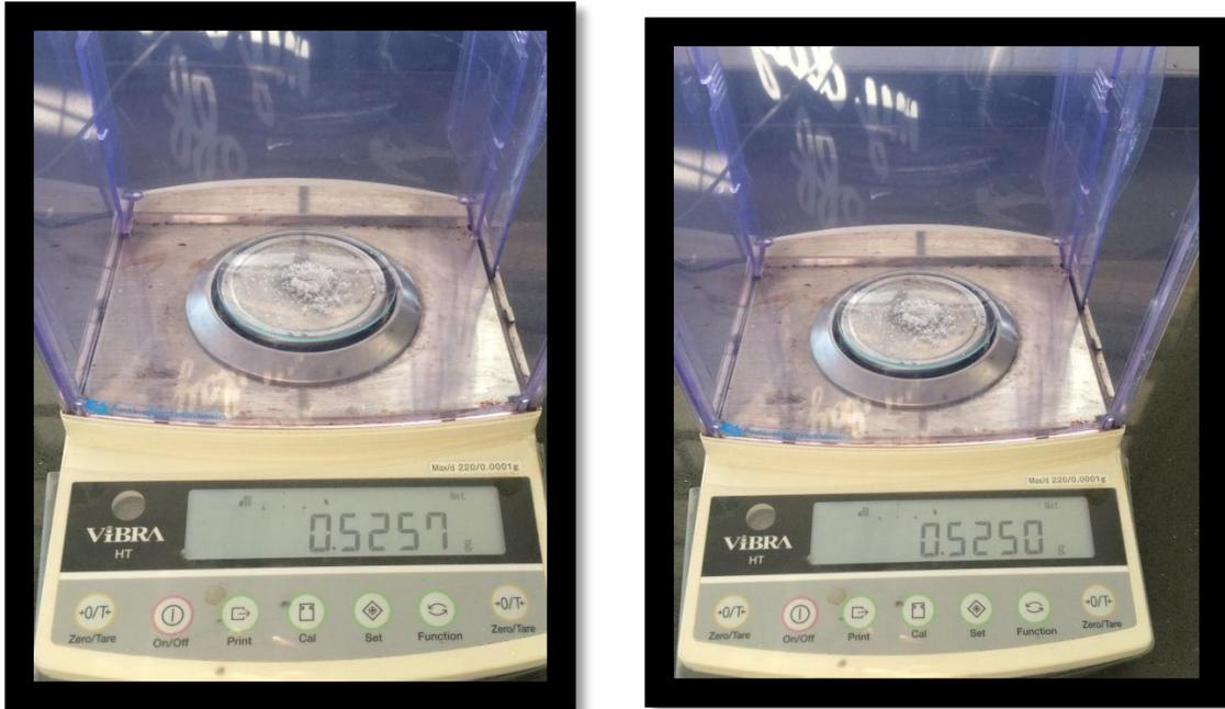
*Figura 18: Balanza electrónica para la determinación del Azúcar*
