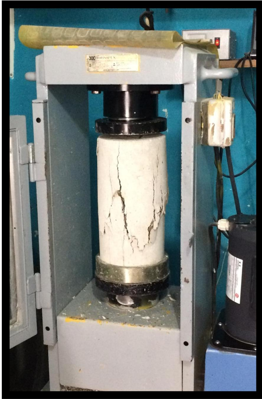
*Figura 17: Ensayo de cilindro a la compresión*
