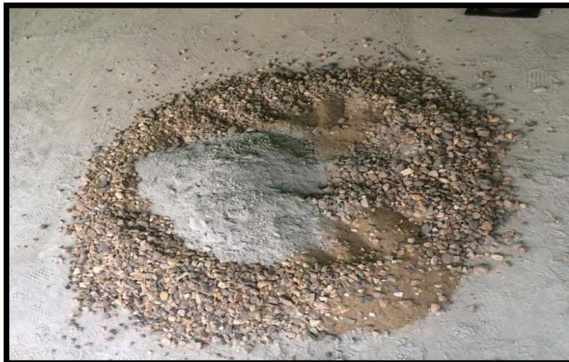
*Figura 9. Materiales utilizados para la mezcla de concreto.*
