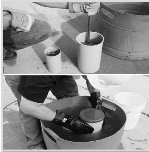
**Figura 3.** Preparación de cilindros de concreto.
