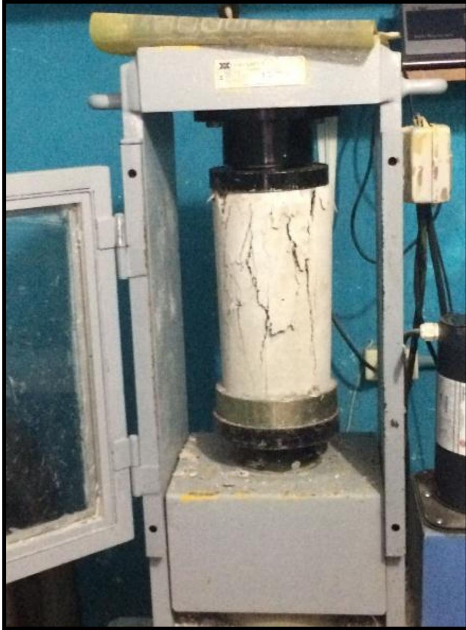
*Figura 15. Ensayo a la compresión del concreto.*
