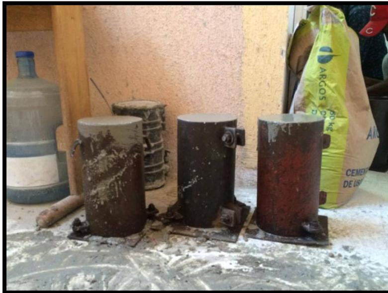
*Figura 11. Probetas de concreto para ensayos a la compresión.*
