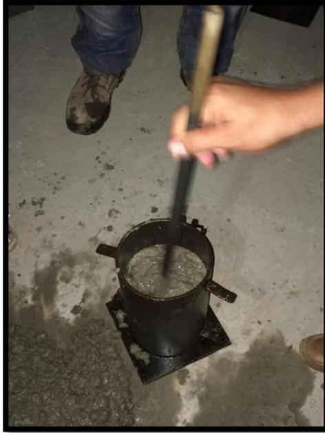
*Figura 8. Elaboración de las probetas de concreto.*
