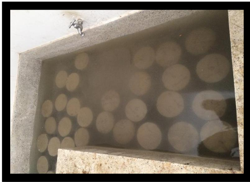
*Figura 19: Probetas en estado de curado del concreto.*
