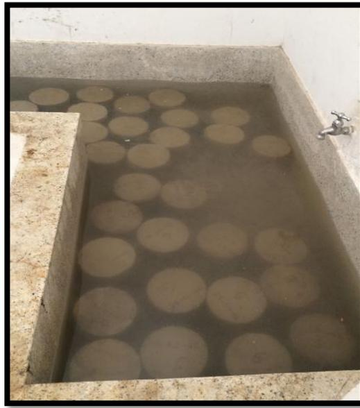
*Figura 7. Probetas en su estado de curado del concreto.*
