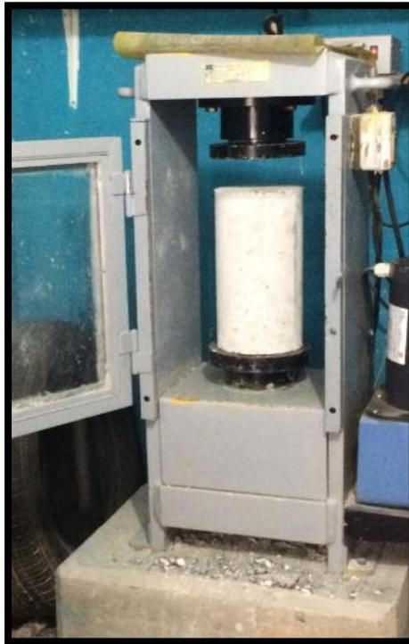
*Figura 13. Maquina universal para el ensayo a la compresión.*
