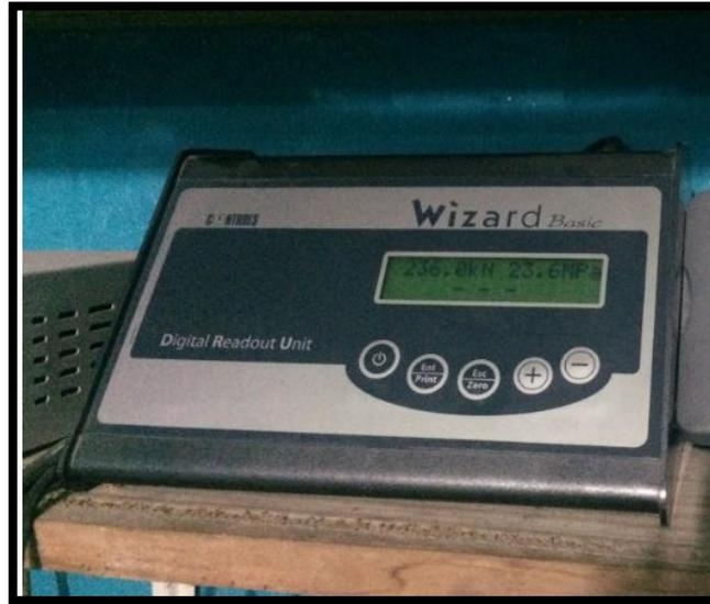
**Figura 14.** Tablero computarizado para medir la carga aplicada.
