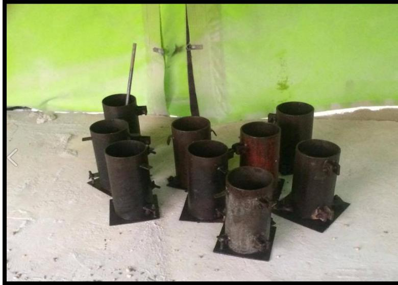
*Figura 10. Moldes utilizados para la elaboración de las probetas.*
