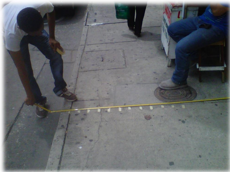
Ilustración 12 .Identificación en campo de restricción y medición de ancho de andén
