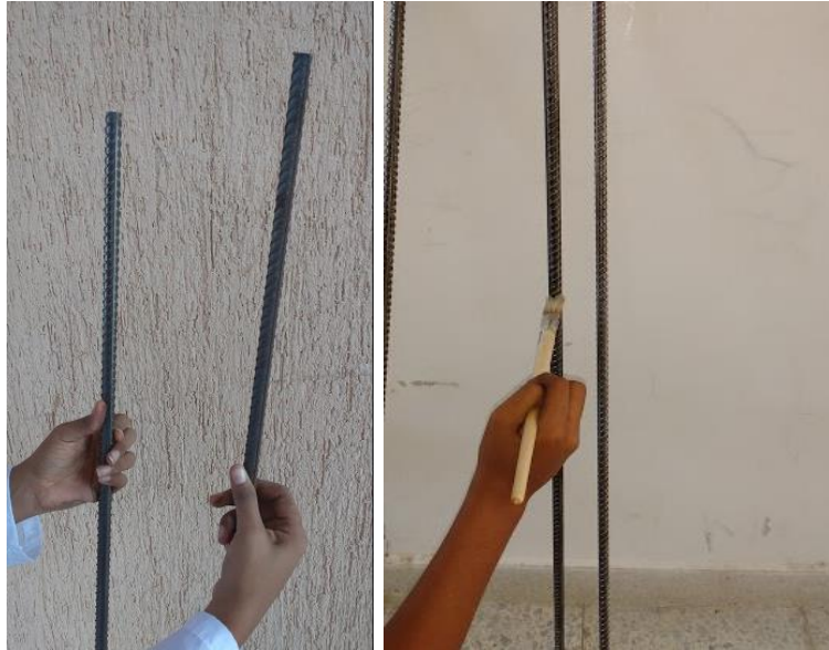
Figura 14. Limpieza y aplicación del exudado con pincel de cerdas suaves sobre las barras limpias.
