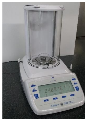
Figura 12: Balanza utilizada para el pesaje de las muestras de acero.
