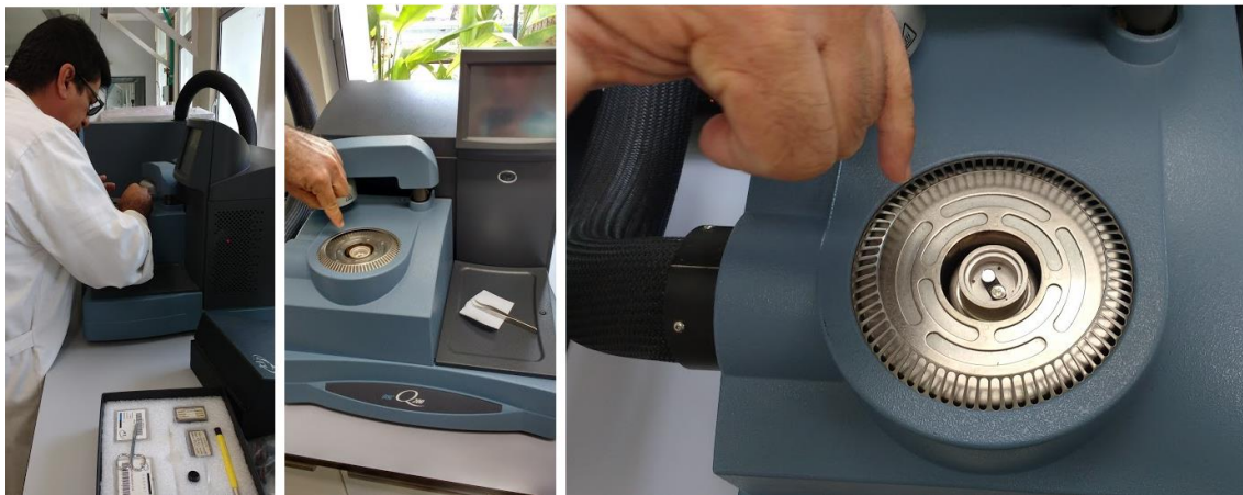
Figura 38. Ejecución de barridos para la prueba de DSC.
