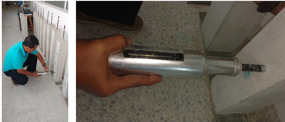
Figura 36. Ensayo con esclerómetro análogo.
