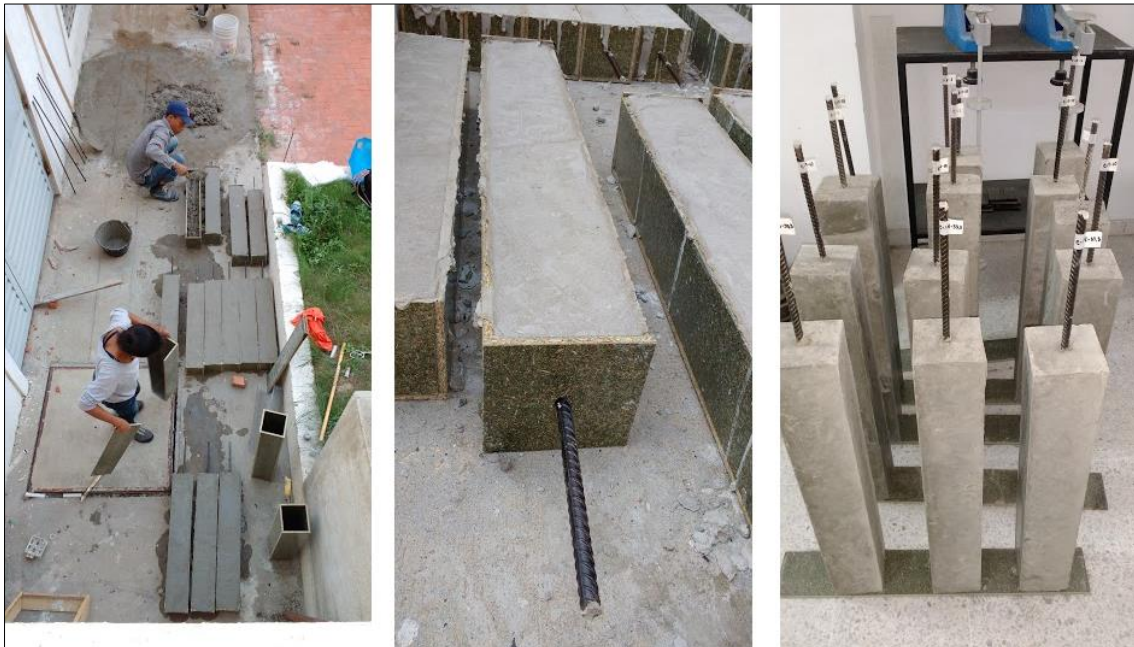
Figura 20. Construcción de probetas para monitoreo con celda electroquímica.
