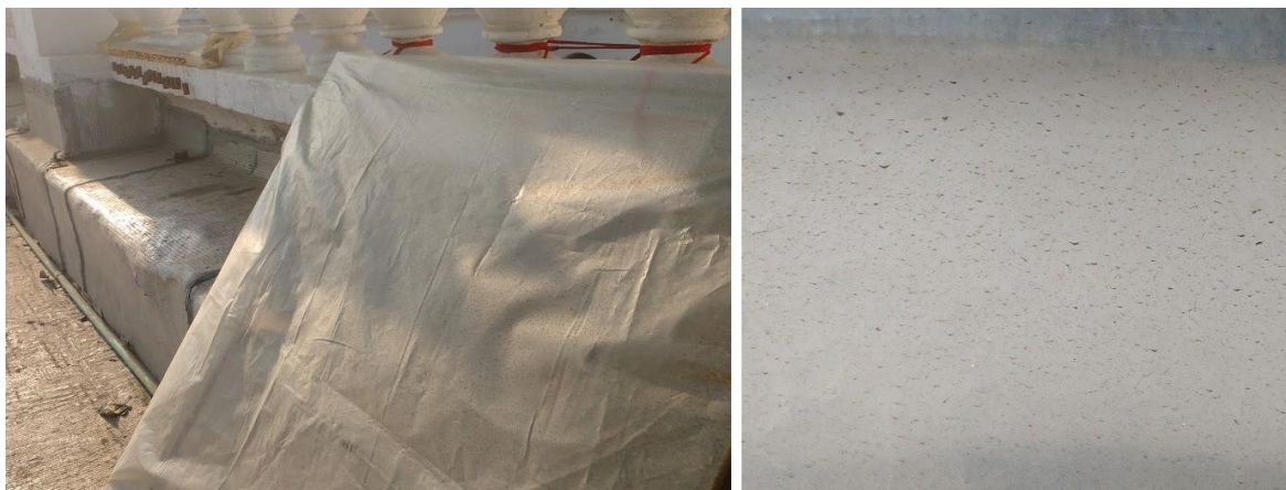
Figura 35. Estado final del polímero liso sometido al ambiente salino del área de influencia para las muestras de la prueba de intemperismo.
