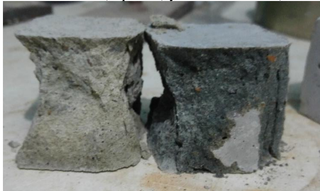
Ilustración 5. Cubo sin ceniza (izquierda) y cubo con ceniza (derecha) fracturados
