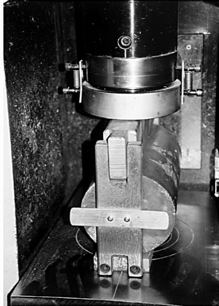
Ilustración B 5. Cilindro colocado para ensayo de tensión indirecta
