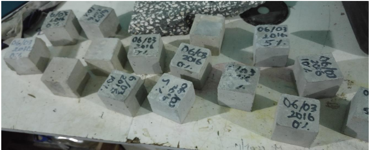
Ilustración 3. Cubos de mortero
