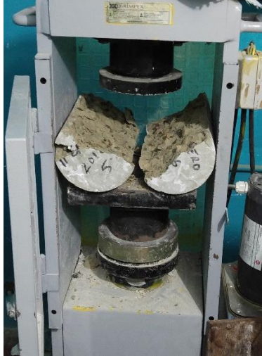
Ilustración 15. Cilindro 2 fracturado después de la fuerza aplicada para la tracción
