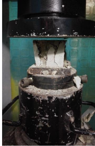
Ilustración 4. Cubo fracturado después de la presión aplicada
