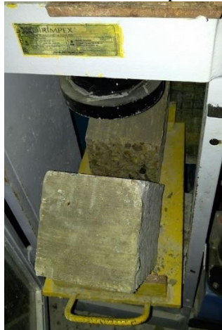
Ilustración 12. Vigueta 1 fracturada después de la presión aplicada
