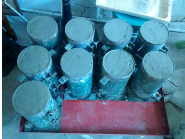
Ilustración 8. Moldes de cilindros de hormigón
