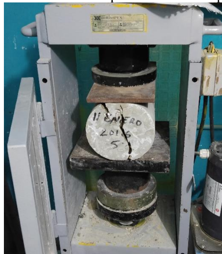
Ilustración 14. Cilindro 1 fracturado después de la fuerza aplicada para la tracción
