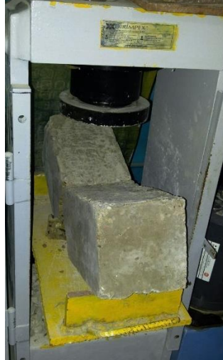
Ilustración 13. Vigueta 2 fracturada después de la presión aplicada
