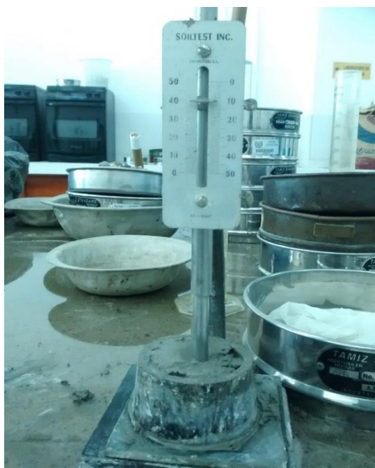
Ilustración 2. Aparato de Vicat en ensayo de consistencia normal
