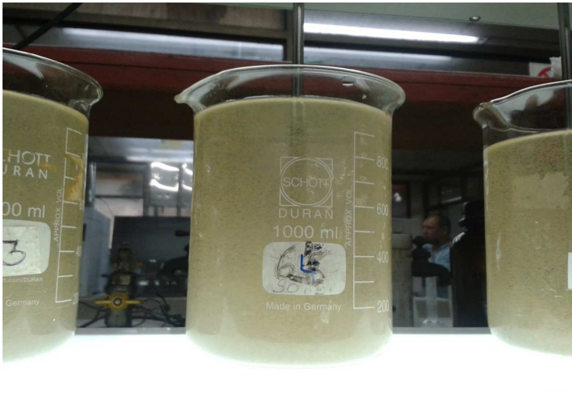
Figura 7. Formacion de flocs en prueba de jarras para agua con alumbre
