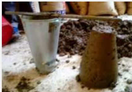
Ilustración 9. Asentamiento a la mezcla y procedimiento del ensayo.
