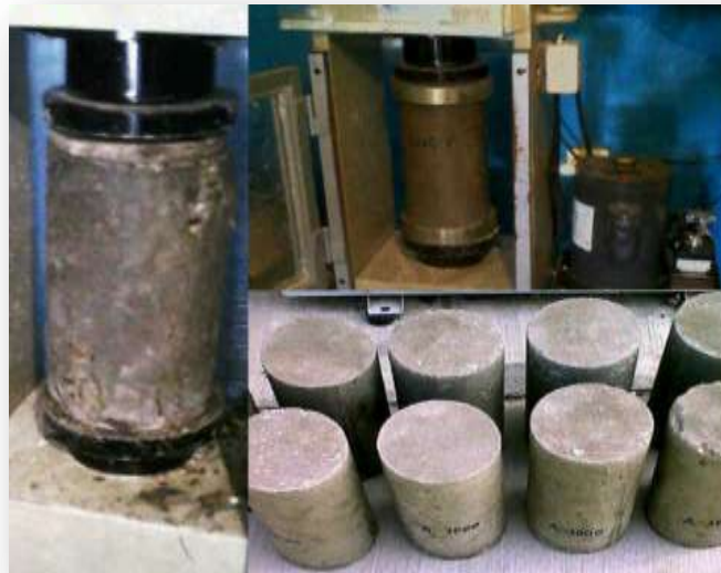
Ilustración 11. Ensayo de compresión a los cilindros.
