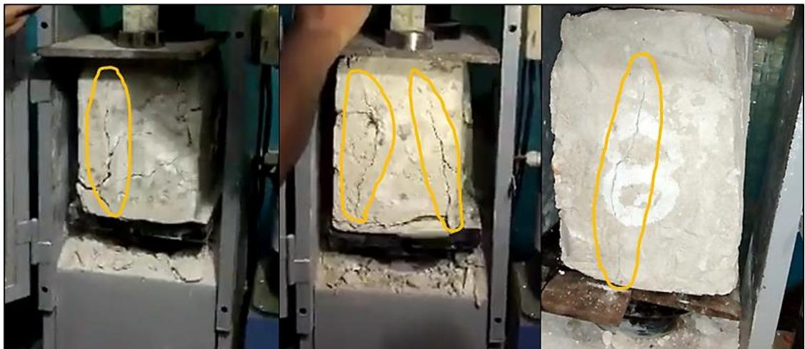
*Ilustración 29 - Patrón de falla en muretes.*
