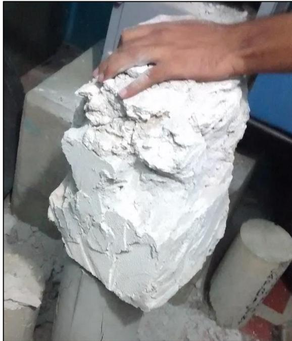
*Ilustración 27 - Murete #9 luego de prueba a compresión.*
