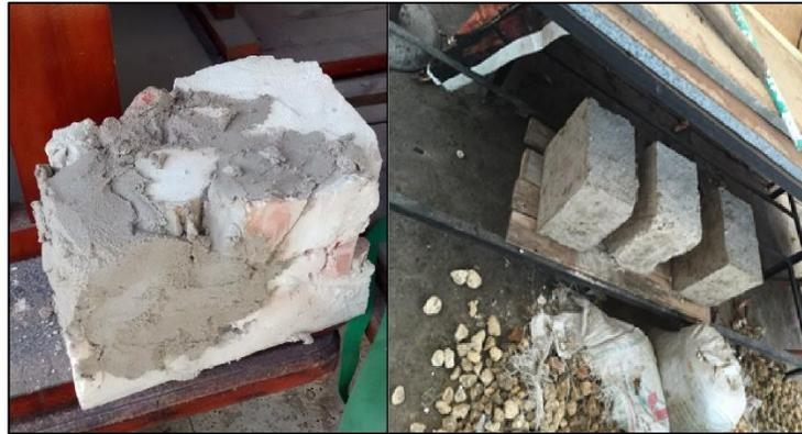
*Ilustración 14 - proceso de pañetado en muretes extraídos.*
