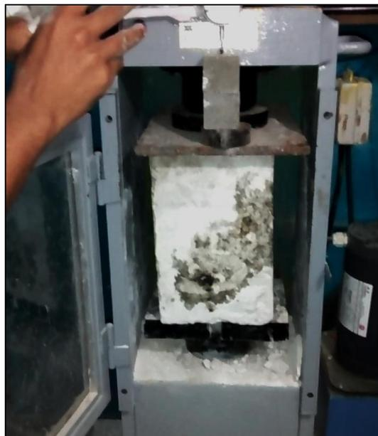
*Ilustración 24 - Ensayo de muretes a compresión.*
