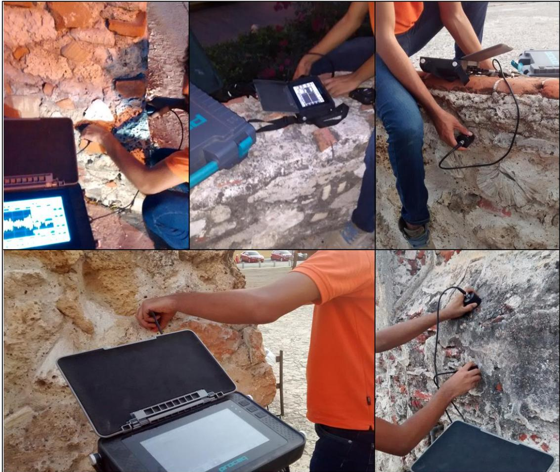
*Ilustración 25 - Ensayo de ultrasonido en la contraescarpa de la muralla.*
