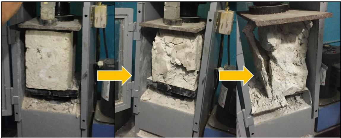
*Ilustración 28 - Proceso de falla en murete.*
