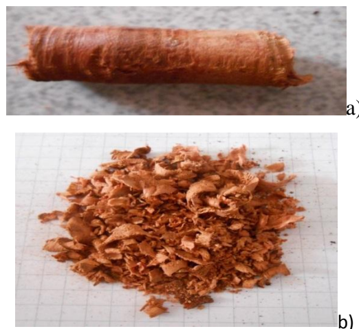
Figura 27. a) Testigo de Guayacán Trébol sano; b) Viruta Fuente: Los autores
