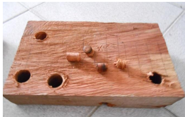
Figura 26. Muestra sana de Guayacán Trébol con los testigos extraídos. Fuente: Los autores.
