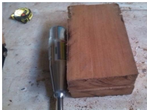
Figura 15. Esclerómetro usado para ensayos no destructivos. Fuente: Los Autores.
