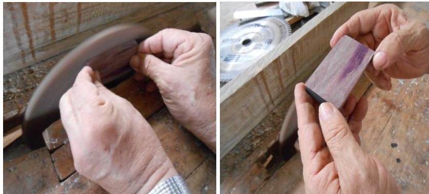
Figura 35. Proceso de pulido y elemento terminado. Fuente: Los Autores.
