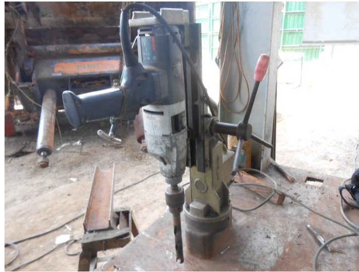
Figura 17. Taladro usado para la extracción de los testigos de madera.
