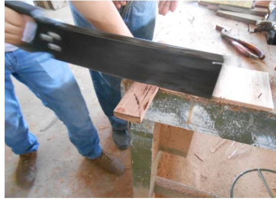
Figura 33. Corte de las muestras con serrucho de corte fino, para una longitud deseada Fuente: Los Autores
