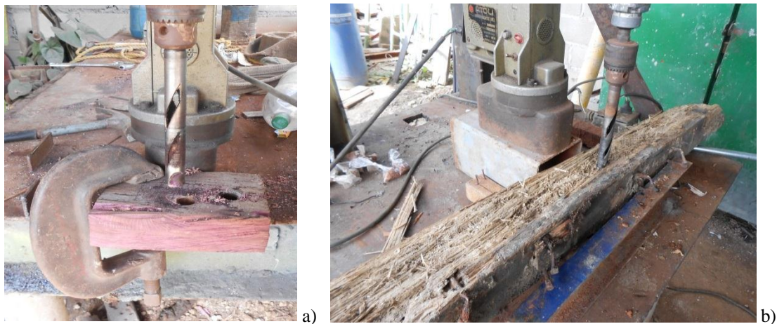
Figura 16. a) Penetración muestra sana; b) penetración muestra deteriorada. Fuente: Los Autores.
