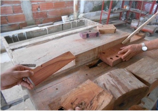
Figura 32. Cortes de las muestras con la sierra Fuente: Los Autores
