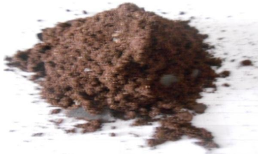
Figura 23. Viruta extraída junto con el testigo de Puy Fuente: Los autores
