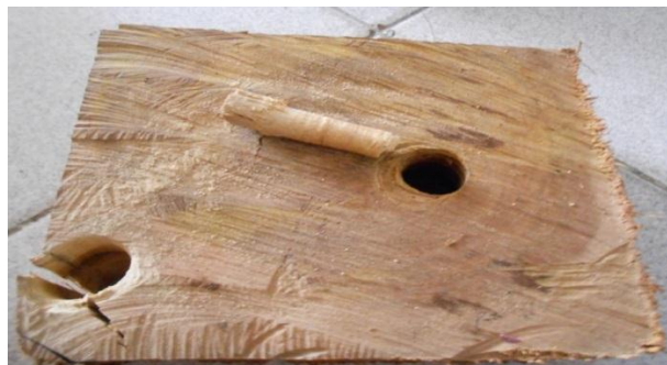
Figura 24. Muestra de Guayacán polvillo con el testigo extraído Fuente: Los autores
