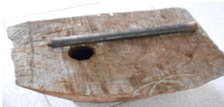
Figura 22. Muestra de Puy con el testigo extraído Fuente: Los autores
