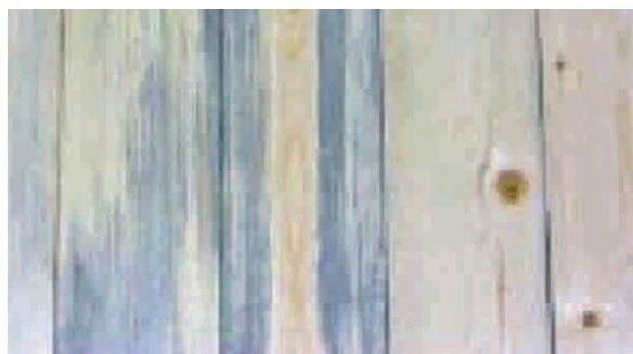
Figura 9. Ataque por hongos en piezas machihembradas de pino Radiata Fuente (Fritz, 2010)
