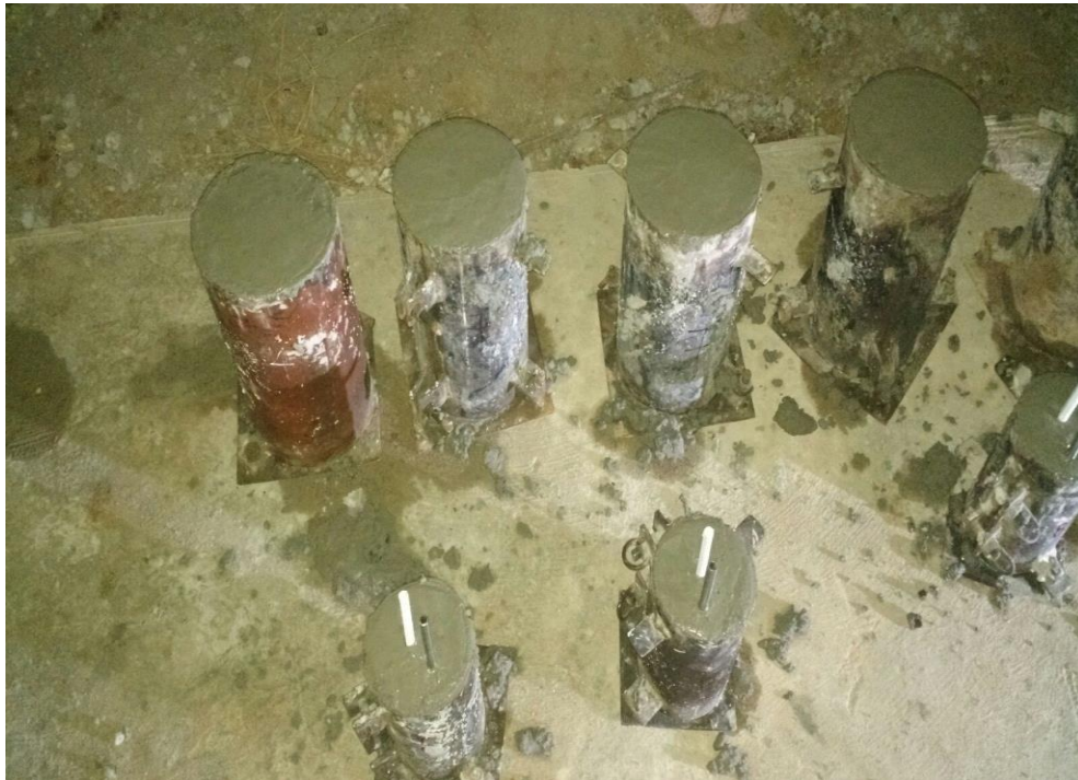
Figura 18. Probetas de concreto utilizadas para ensayos a compresión y a velocidad de corrosión.
