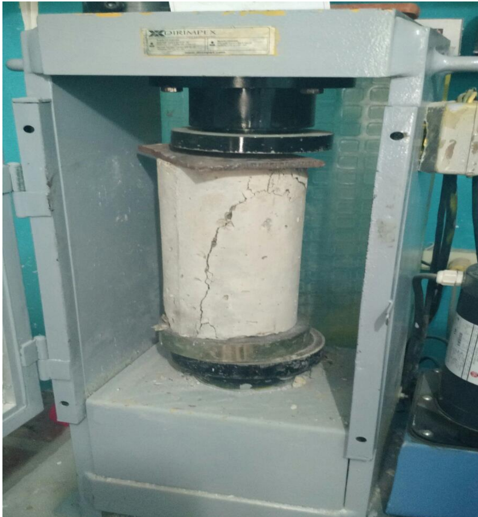
Figura 21. Ensayo a compresión del concreto
