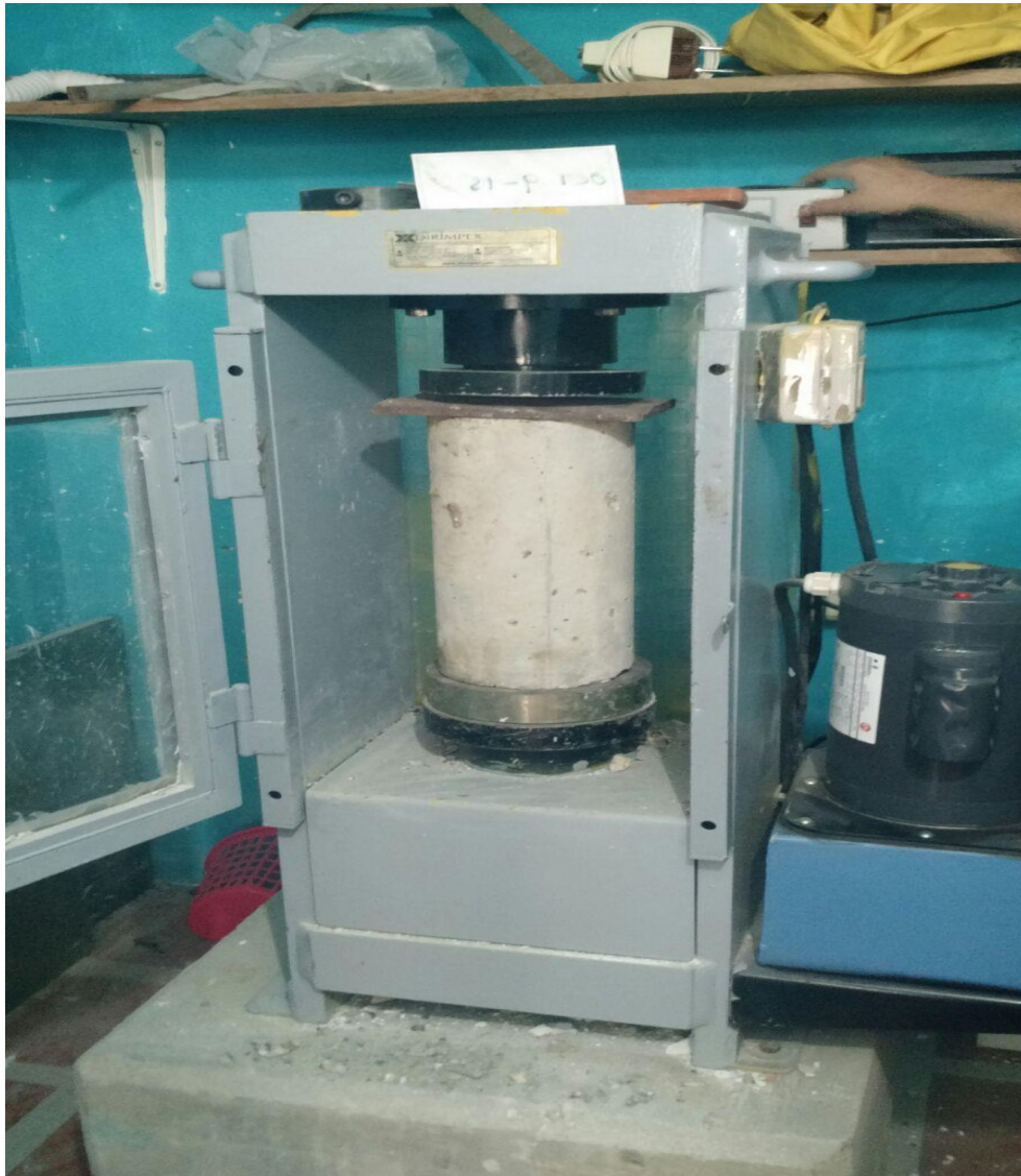
Figura 20. Ensayo a compresión del concreto
