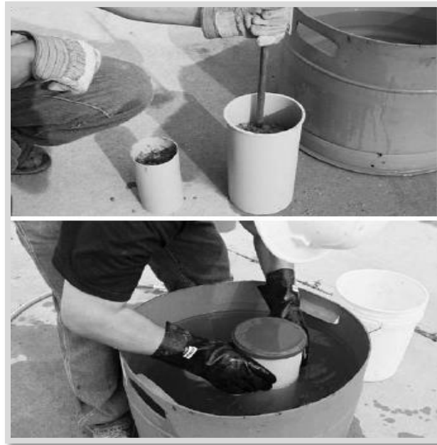
Figura 11. Preparación de cilindros de concreto.
