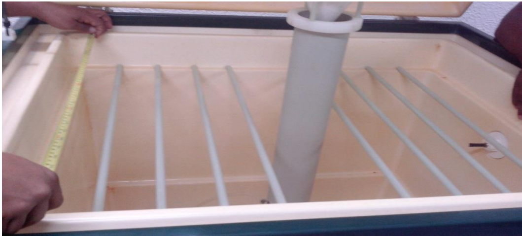
Figura 22. Cámara de niebla salina utilizada para simular ambiente agresivo.
