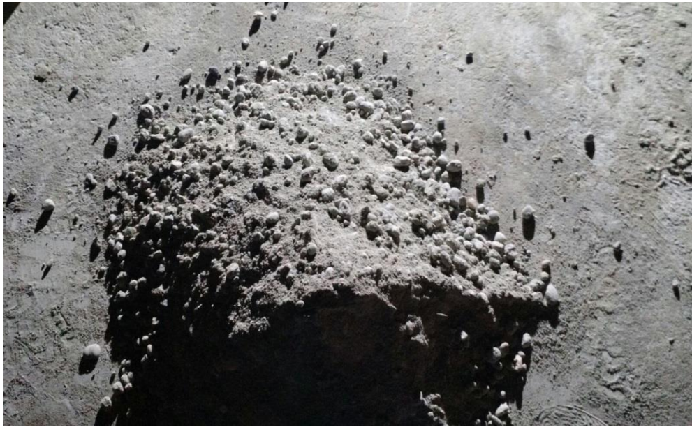
Figura 14. Agregados utilizados en la elaboración de la mezcla de concreto
