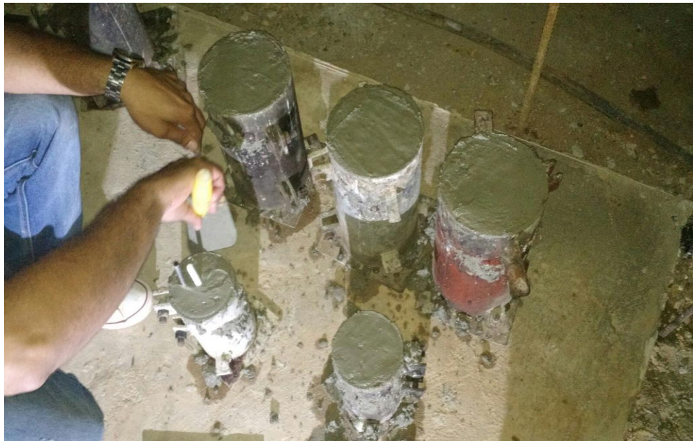
Figura 17. Probetas de concreto para ensayos a compresión
