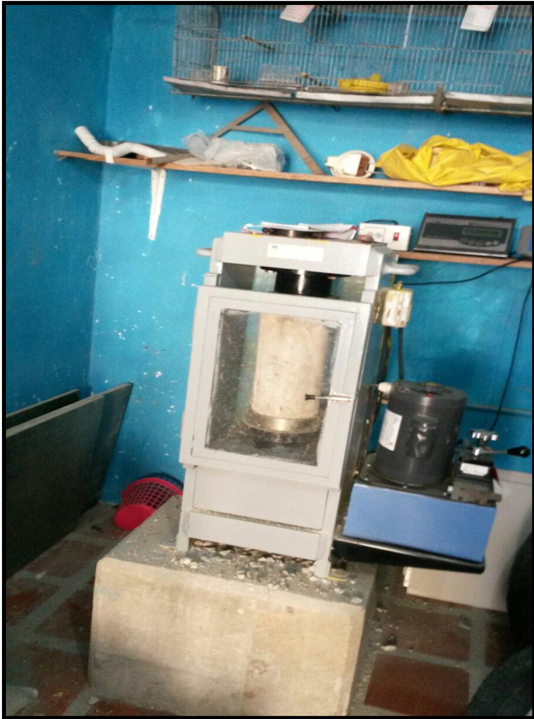
Anexo II. Ensayo de probetas de concreto.
