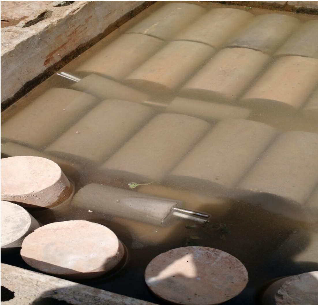
Figura 19. Muestras en estado de curado del concreto
