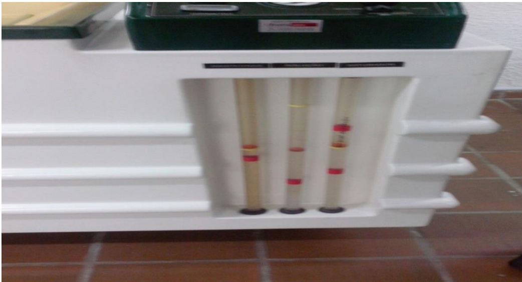
Figura 23. Elementos de Cámara de niebla salina utilizada para simulación de ambiente agresivo
