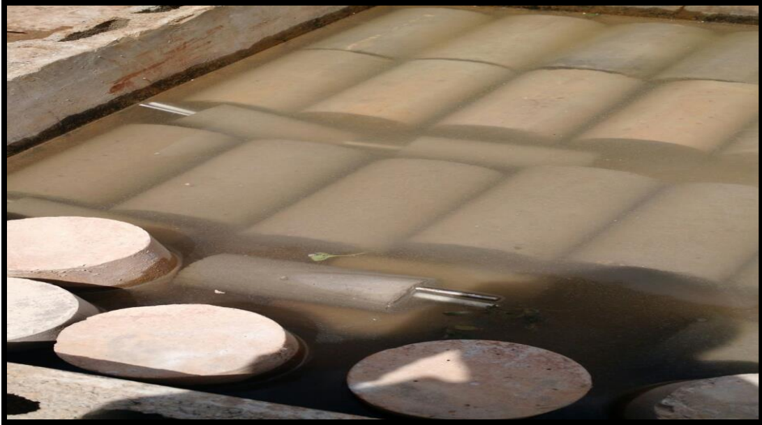
Anexo 9. Curado de probetas cilíndricas de concreto para ensayos a compresión
