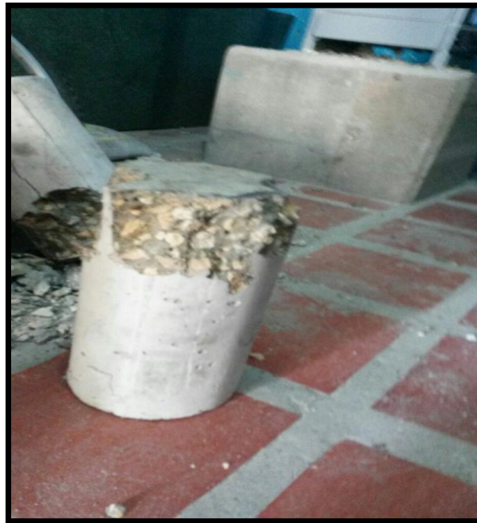
Anexo 10. Probeta de concreto ensayada a los 28 días
