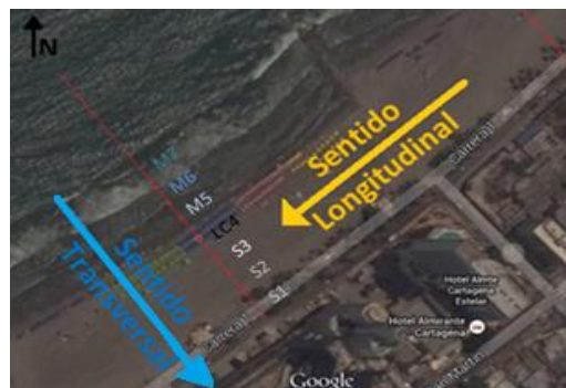
Figura 54 Sentido A Ubicación de los puntos de toma de muestras y sentido longitudinal y transversal del transporte de sedimentos
