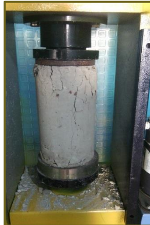
Ilustración 5. Compresión a los 14 días – máquina de compresión Fuente: Autores
