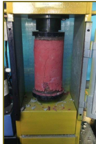
Ilustración 9. Compresión a los 28 días del concreto con pigmento inorgánico Fuente: Autores
