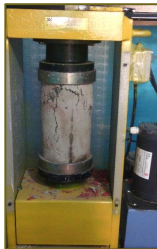
Ilustración 10. Compresión a los 7 días del concreto con pigmento orgánico.
