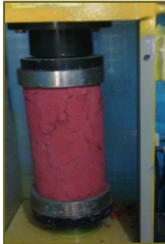
Ilustración 8. Compresión a los 14 días del concreto con pigmento inorgánico. Fuente: Autores
