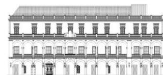
Las casas 1 y 2, poseen un sistema estructural basado en muros de carga apoyados en arcos externos que descansan sobre zapatas hechas a base de concreto ciclópeo. Este método constructivo, es propio de las edificaciones coloniales realizadas por el Imperio Español por toda América Latina.
