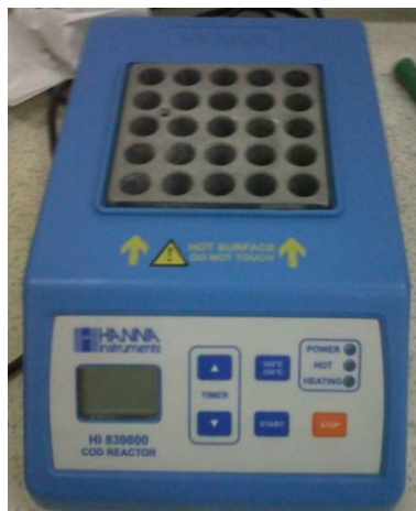
Figura 16 Reactor HI 839800 para calentar tubos de ensayos marca Hanna Instruments.
