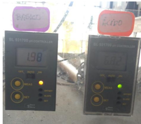
Figura 18 Mini controlador de pH, BL931700 marca Hanna Instruments
