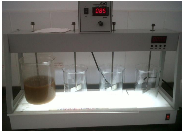
Figura 22 proceso de desmineralización del polvo de caparazón de camarón.
