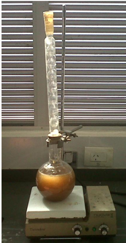
Figura 23 Montaje del proceso de desproteínización química.
