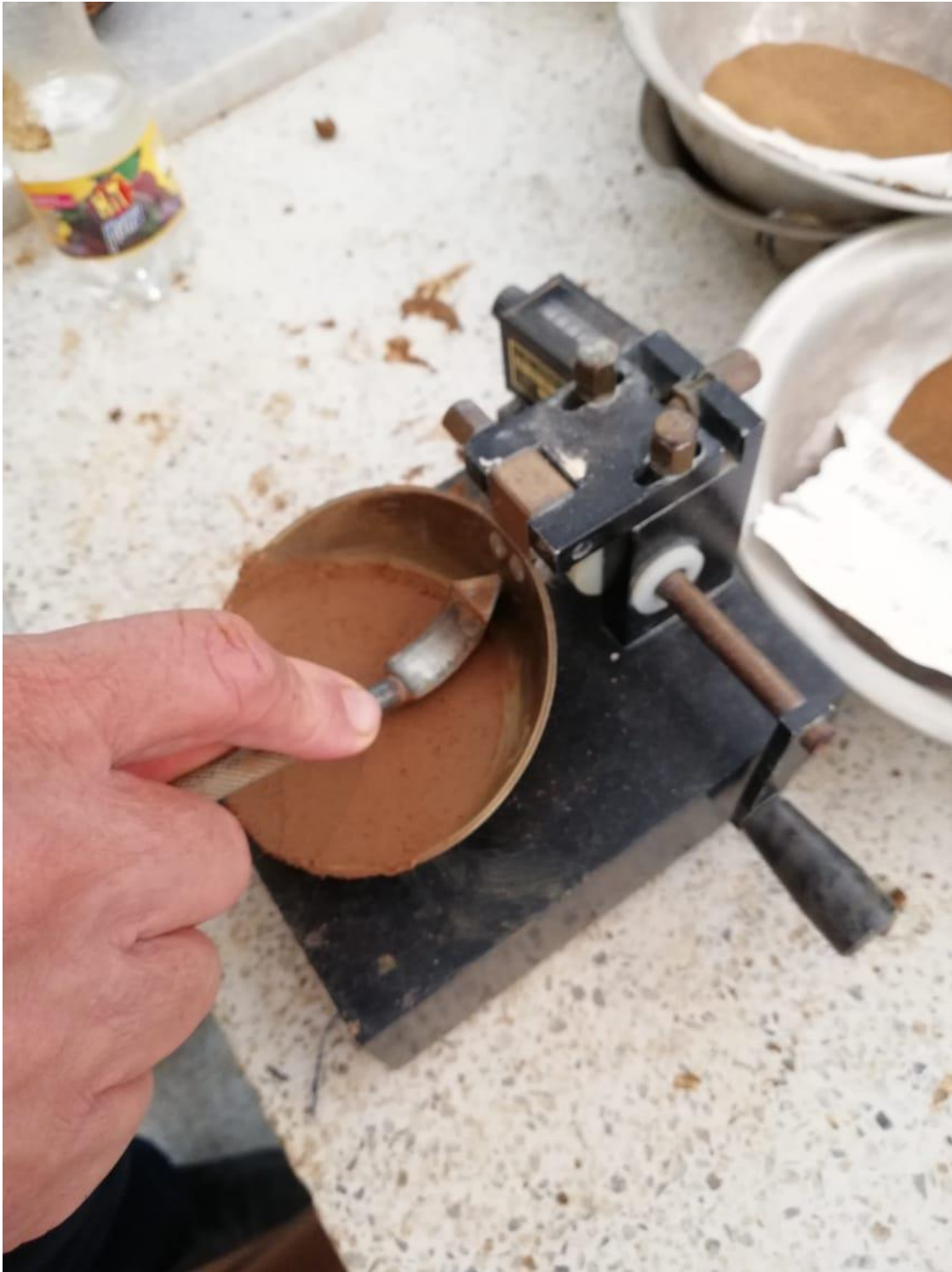
Imagen 2. Ensayo en cazuela de Casagrande para obtención de límite líquido. Fuente: elaboración propia.
