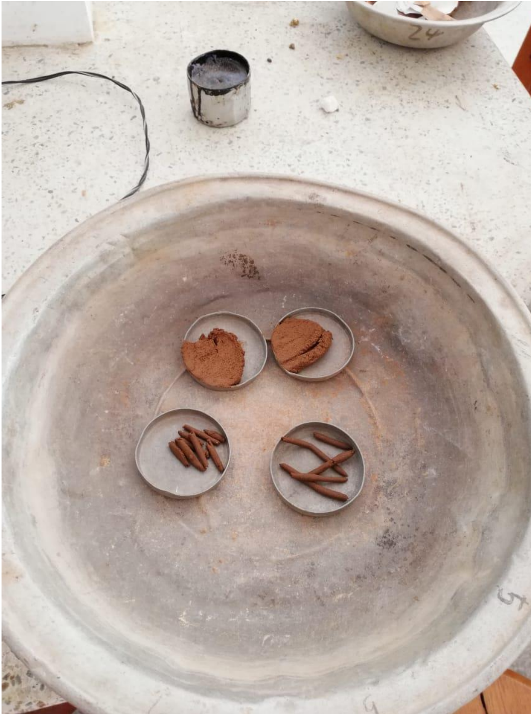
Imagen 3. Muestras extraídas de los ensayos de limite líquido y plástico, para calcular el contenido de agua correspondiente. Fuente: elaboración propia.
