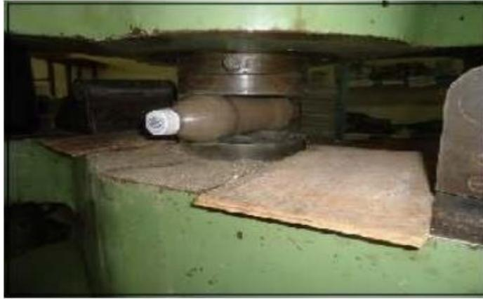
*Ilustración 7. Prueba aplicada en botellas de PET llena de desechos.
