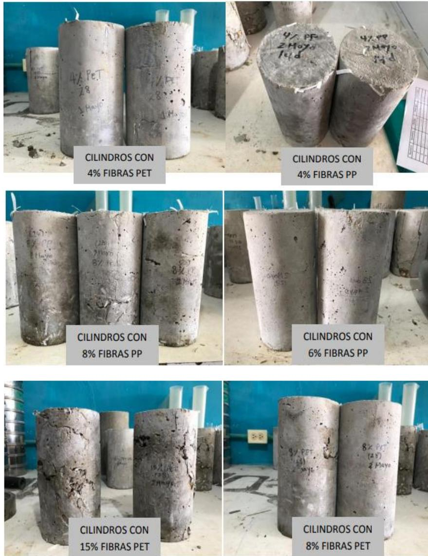
*Ilustración 2. Muestra de porosidad en cilindros por porcentaje agregado.
