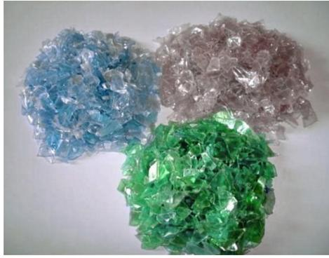
**Ilustración 4.** *Fibras de PET en forma de escamas.*
