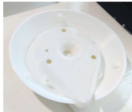
Ilustración 93 Impresión 3D de la Base del Panel y la PCB vista trasera
