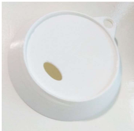
Ilustración 92 Impresión 3D de la base del Panel Solar y la PCB
