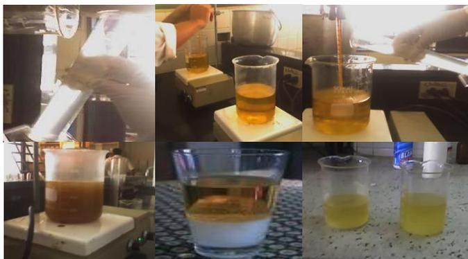
**Figura 23.** Montaje general de reacción de transesterificación
