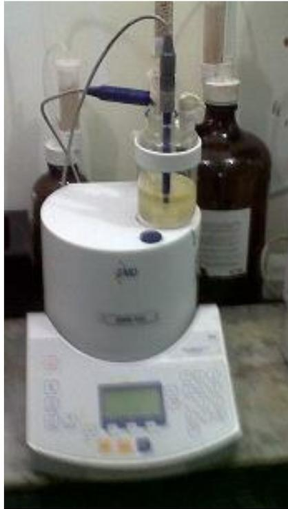
**Figura 15.** Equipo de Agua por Karl Fisher Coulométrica, ASTM D-6304.
