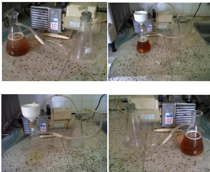
**Figura 18.** Filtrado al vacío
