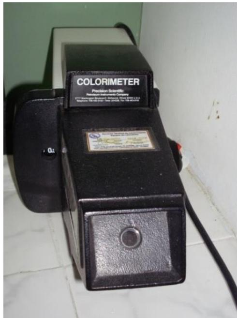
**Figura 13.** Equipo de Color ASTM, ASTM D-1500.
