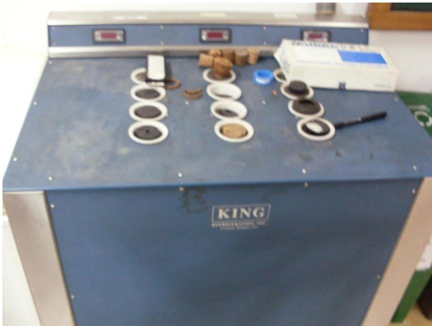
**Figura 11.** Equipo Cloud Point (Punto de Nube), ASTM D-2500 y Pour Point (Punto de Fluidez), ASTM D-97.
