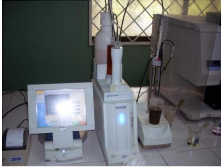
**Figura 16.** Equipo de Acidez, ASTM D-664.
