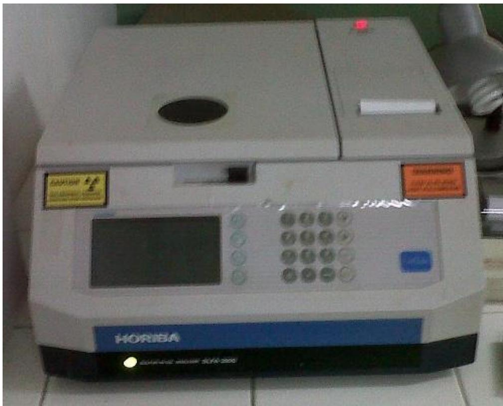
**Figura 14.** Equipo de Azufre por rayos X, ASTM D-4294.
